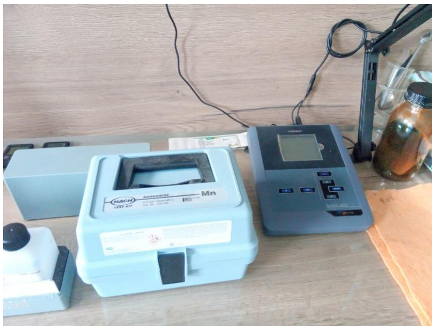
Obrázek č. 11. Přístroj pro testování HACH – test kit MANGANESE, HACH – Aluminium test. (Fotografie vlastní)
