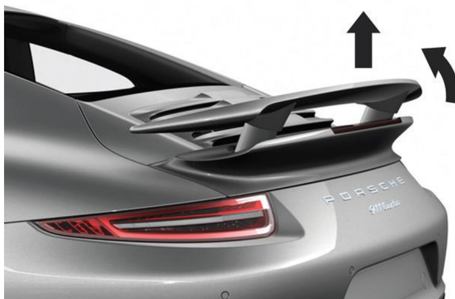
Obr. 18 Zadní křídlo vysunuté a natočené na maximum [2]
