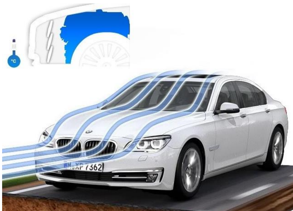
Obr. 31 Proudění vzduchu kolem vozu s uzavřenými klapkami [9]
