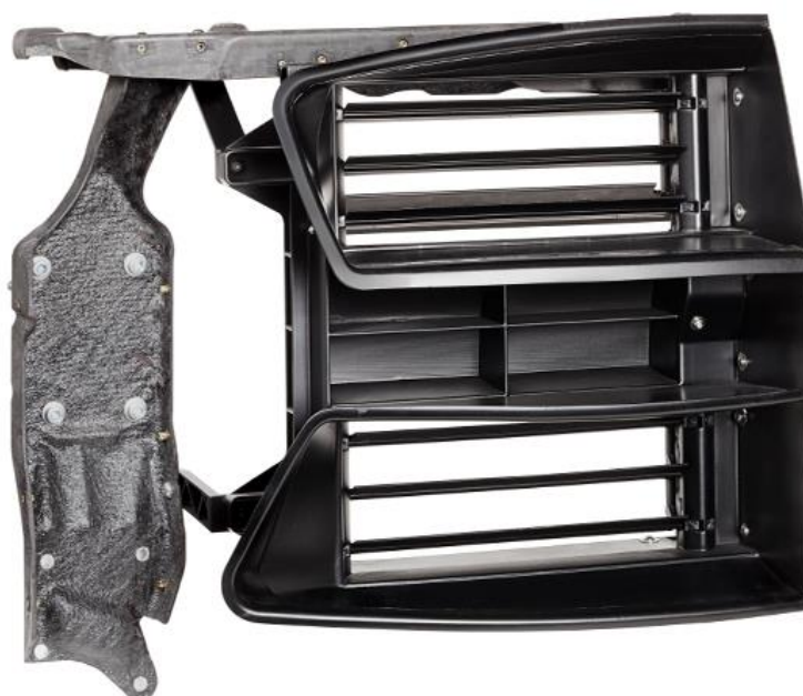
Obr. 34 Ukázka aktivních větracích klapek [14]
