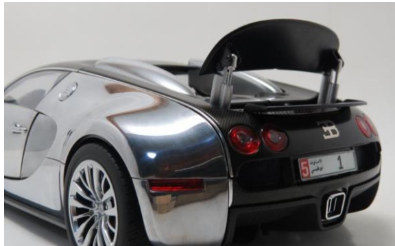
Obr. 20 Zadní křídlo jako aerodynamická brzda na voze Bugatti Veyron [16]
