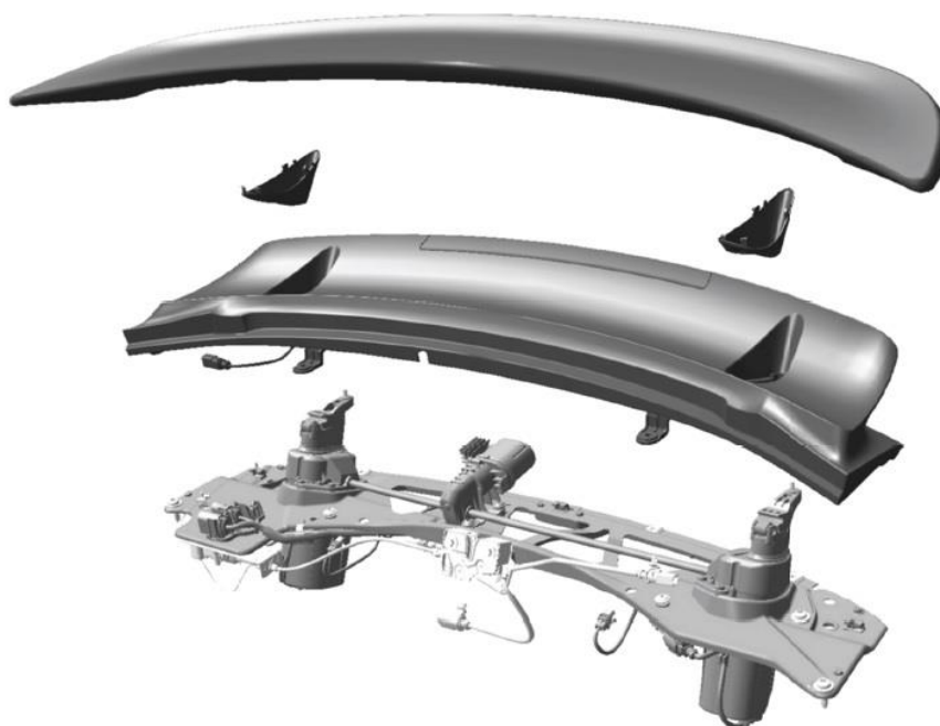
Obr. 19 Schéma složení aktivního zadního přitlačného křídla [2]
