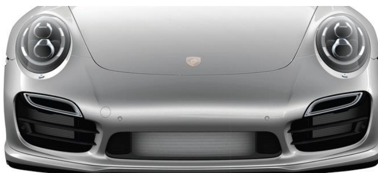
Obr. 11 Zasunutý přední spoiler při nízkých rychlostech [2]
