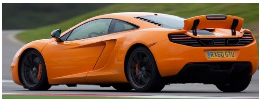
Obr. 21 Aerodynamická brzda na voze McLaren MP4-12C [17]
