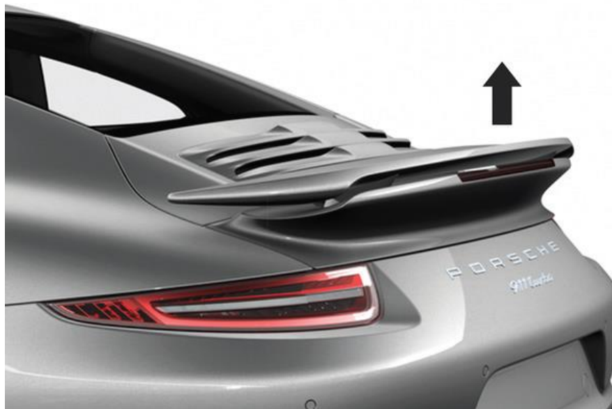
Obr. 17 Částečně vysunuté zadní křídlo [2]
