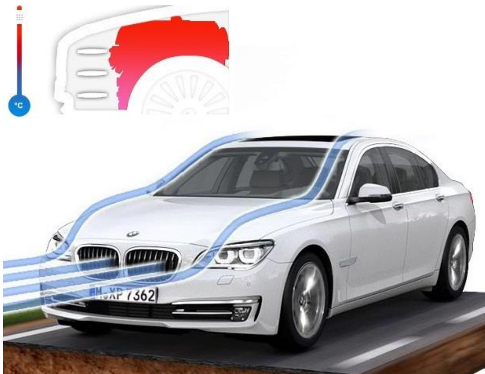
Obr. 32 Proudění vzduchu kolem vozu s otevřenými klapkami [9]
