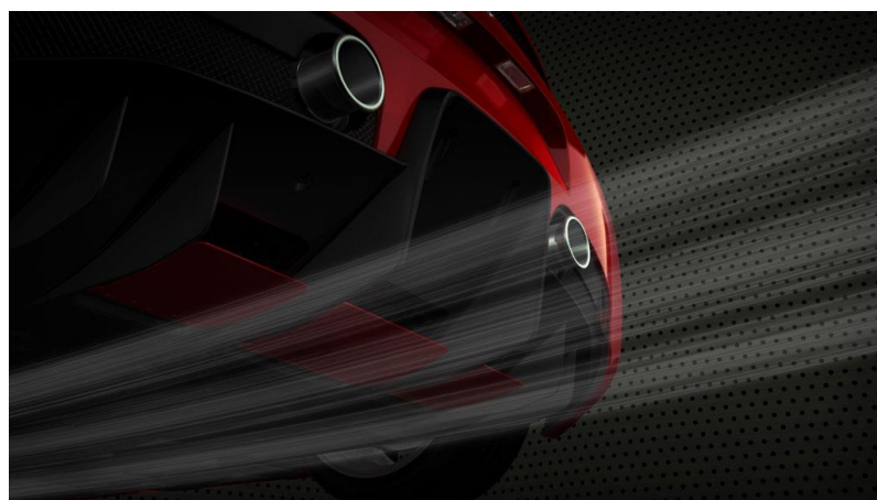
Obr. 27 Natočené klapky na Ferrari 458, dosahujeme nižšího aerodynamického odporu [25]
