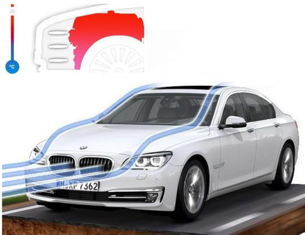
Obr. 32 Proudění vzduchu kolem vozu s otevřenými klapkami [9]
