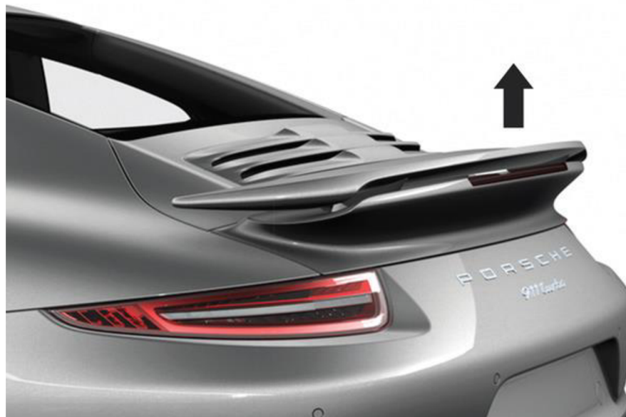
Obr. 17 Částečně vysunutě zadní křídlo [2]
