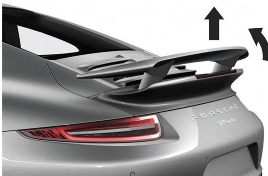
Obr. 18 Zadní křídlo vysunutě a natočené na maximum [2]
