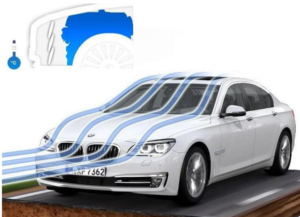
Obr. 31 Proudění vzduchu kolem vozu s uzavřenými klapkami [9]
