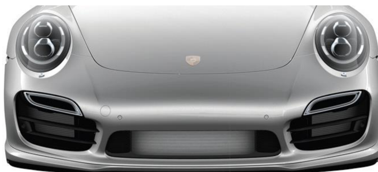
Obr. 11 Zasunutý přední spoiler při nízkých rychlostech [2]
