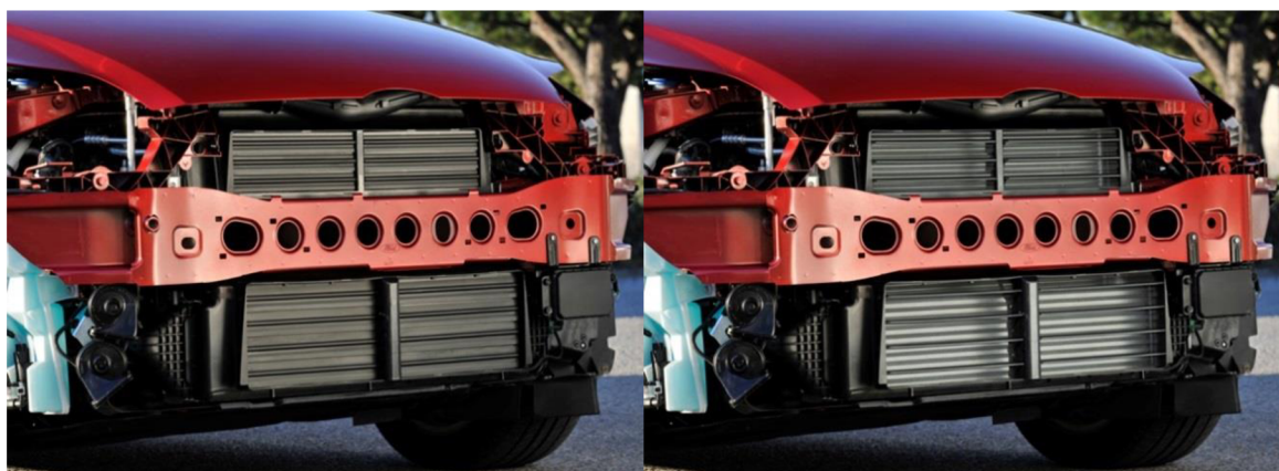
Obr. 33 Uzavřené klapky (vlevo) a otevřené klapky (vpravo) na voze Ford Focus [3]
