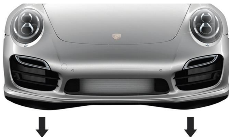
Obr. 12 Částečně vysunutý přední spoiler [2]
