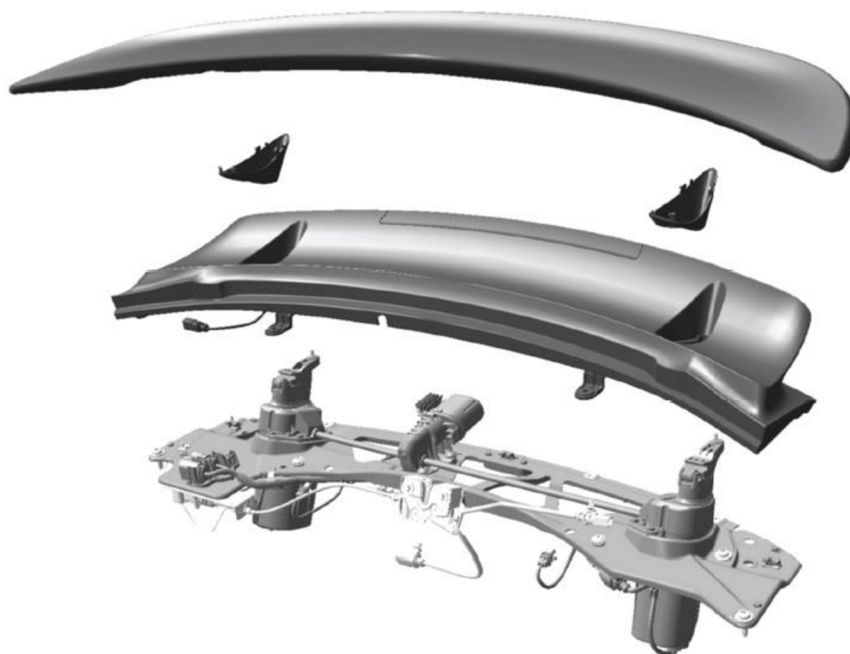
Obr. 19 Schéma složení aktivního zadního přitlačného křídla [2]
