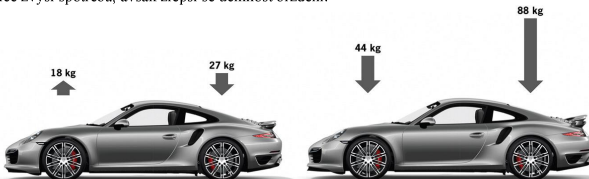
Obr. 28 Aerodynamická síla při rychlosti 300km/h ve 2. módu (vlevo) a ve 3. módu (vpravo) [2]
