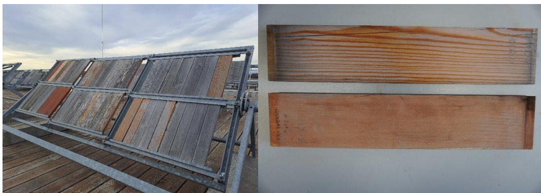
Obrázek 7 - přirozené stárnutí dřeva v exteriéru a testovaný vzorek (vlastní zdroj)
