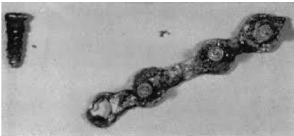
Obr. 14, Laneova dlaha podlehnající korozi
