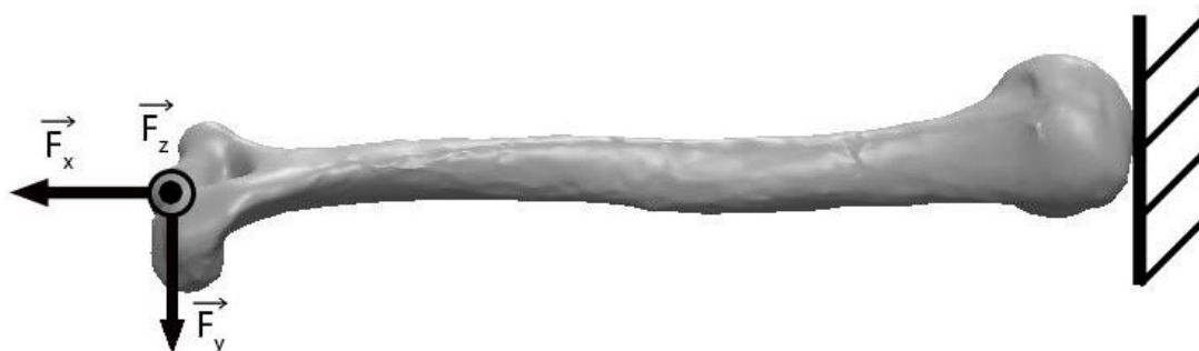
Obr. 44, Zatížení a uložení kosti
