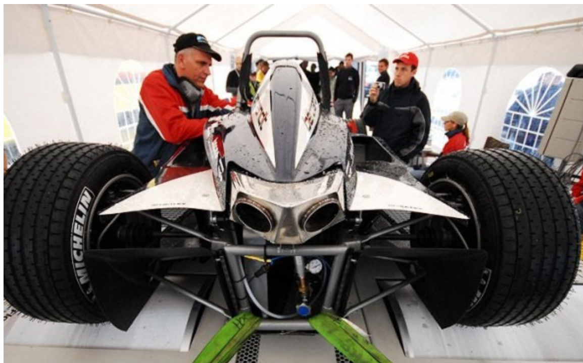
Obr. 21 Zvláštní konstrukce výfukového tlumiče
