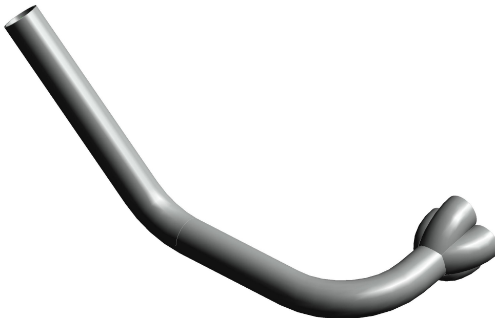
Obr. 58 Sběrná trubka, vedoucí k tlumiči hluku, se spojením svodů
