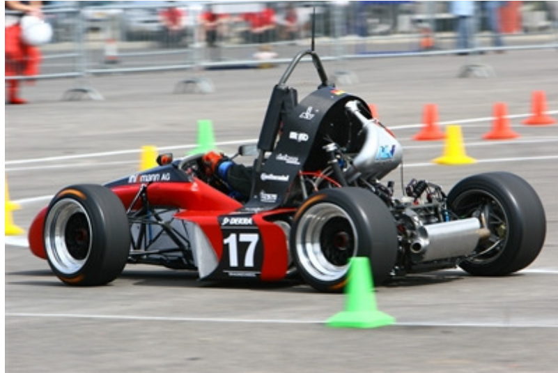
Obr. 15 Centrální umístění výfuku napříč za zadní nápravou, tlumič vlastní konstrukce
