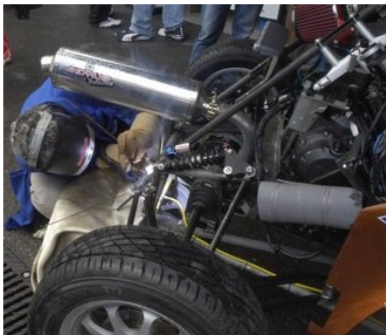
Obr. 13 Centrální umístění výfuku nad pohonem zadních kol
