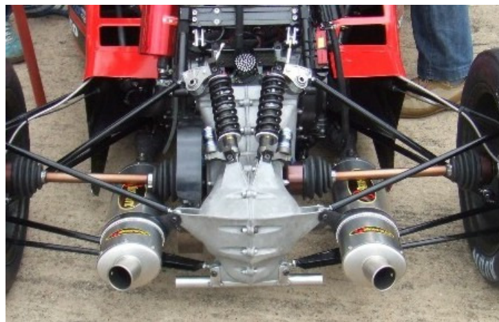
Obr. 20 Výfukový systém s dvěma tlumiči hluku
