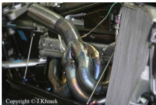
Obr. 45 a Obr. 46 Svody spojené do jedné sběrné trubky u vozů Formule 1
