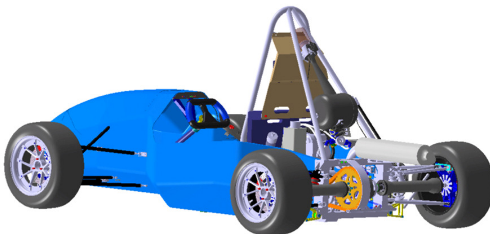
Obr. 12 Centrální umístění výfuku nad pohonem zadních kol
