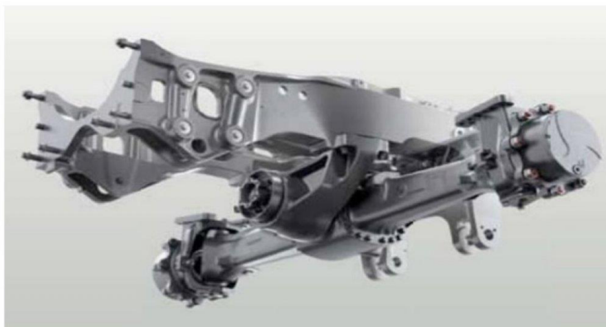
Obrázek 2 Vizualizace polo-rámové konstrukce
