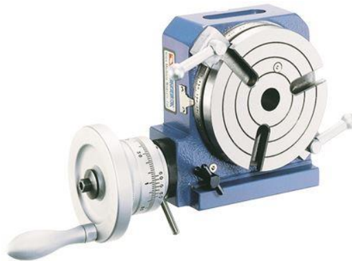
Obr. 15) Otočný stůl pro upnutí ve vertikální i horizontální poloze [11]
