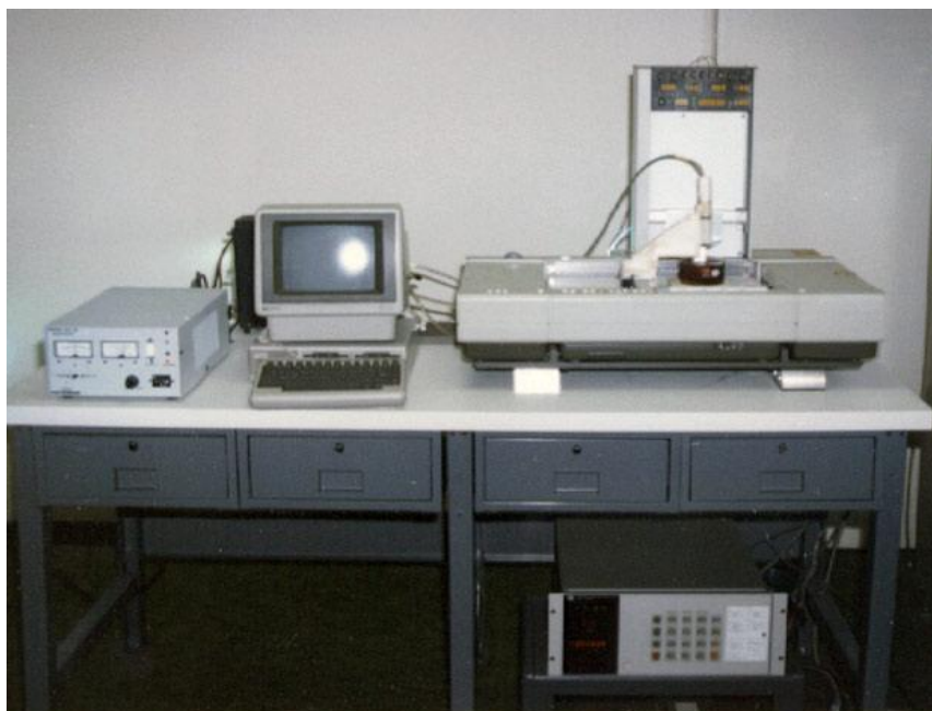
Obrázek 7 - První 3D tiskárna na světě
