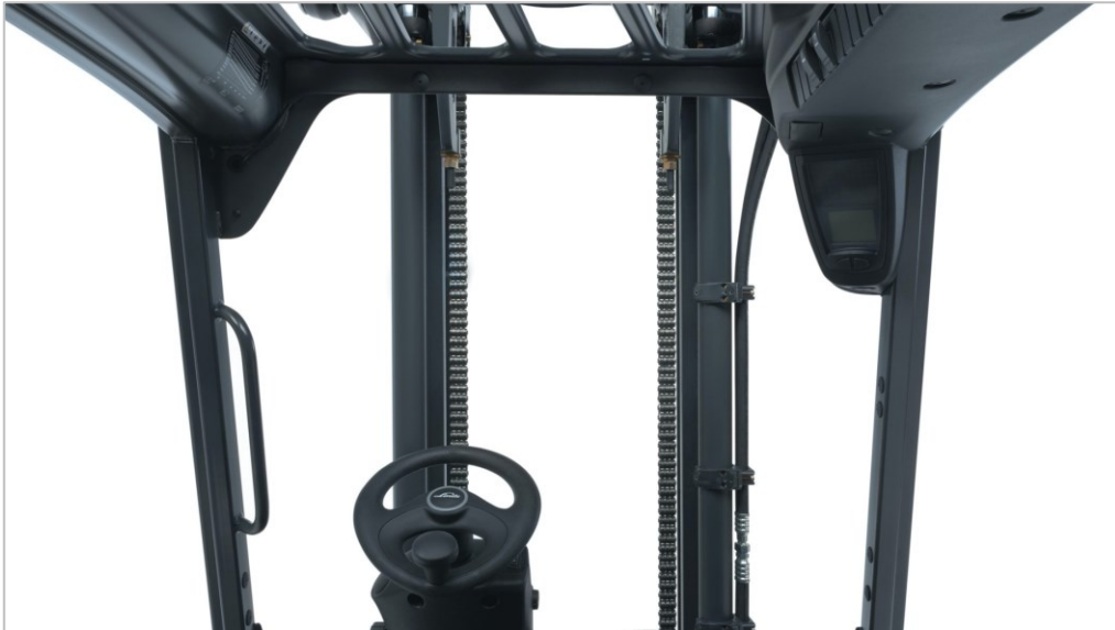
Obrázek 2.1: Ochranný rám Protector Frame Linde
