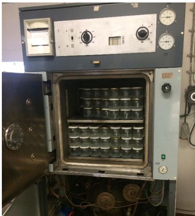
Obr.1 Autokláv s připravenými médii k autoklávování
