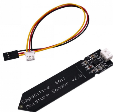
Obrázek 1.4: Ukázka půdního analogového vlhkoměru s antikorozií sondou v2.0 k platformě Arduino v ceně 43 Kč, převzato z portálu drátek.cz
