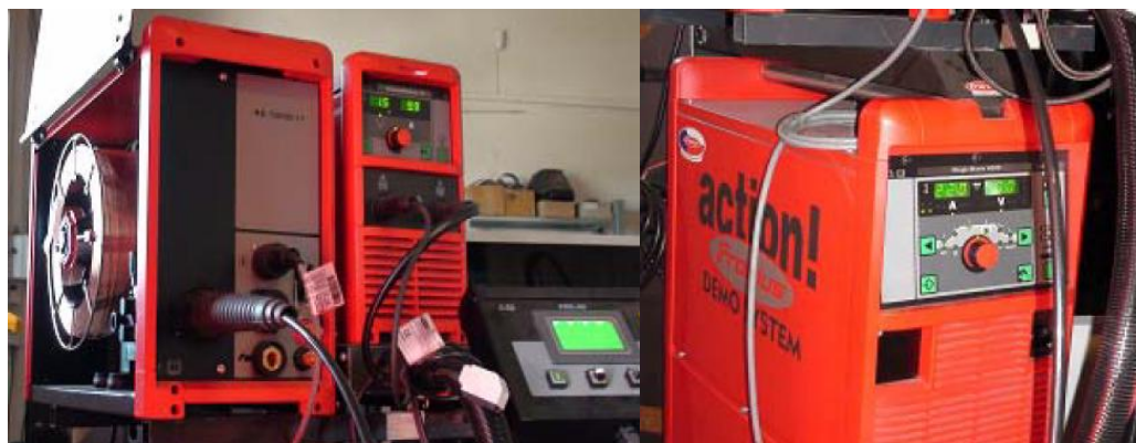
Obr. 5.6 Svařovací zdroj MagicWave 4000, podavač KD 7000 D – 11, PlazmaModule 10
