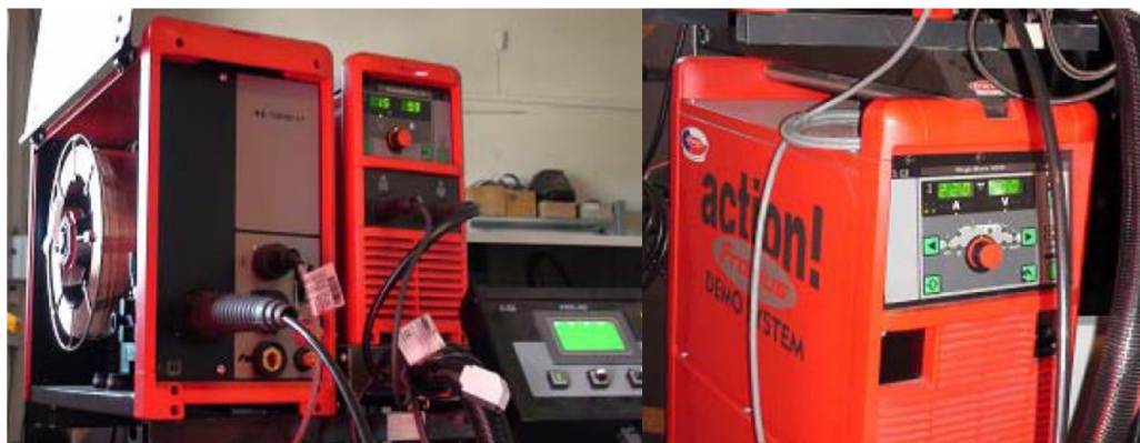
Obr. 5.6 Svařovací zdroj MagicWave 4000, podavač KD 7000 D – 11, PlazmaModule 10
