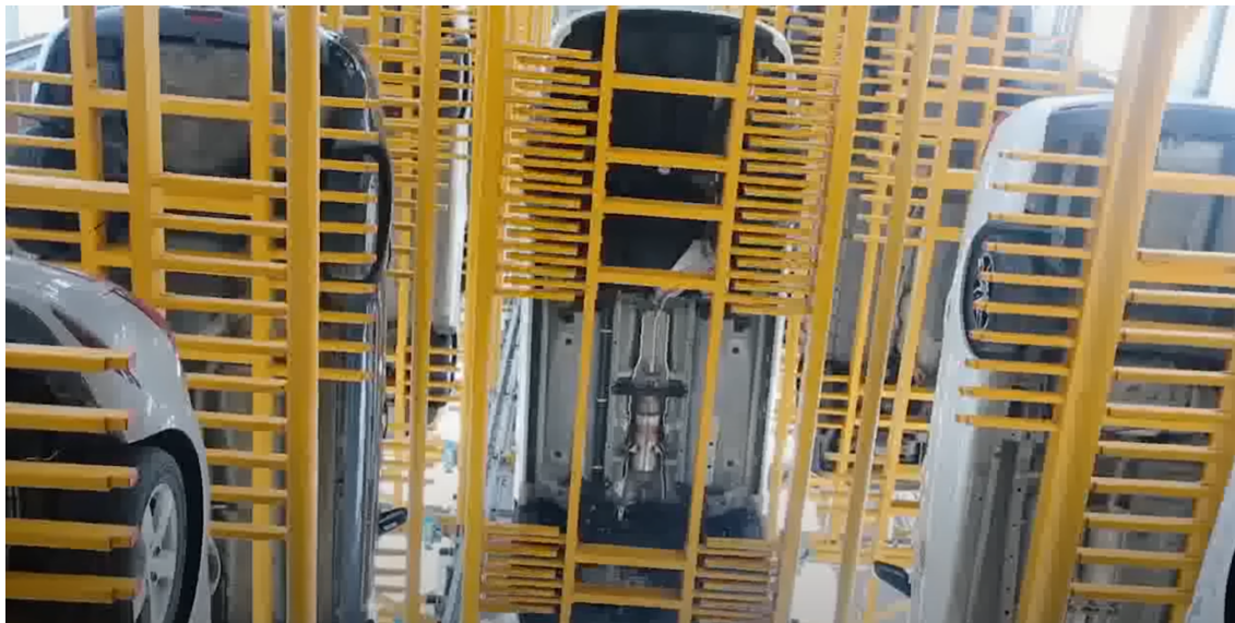
Obrázek 12 - Pohled zespodu na roštové řešení při předání vertikálního a horizontálního roštu (zdroj: [41])
