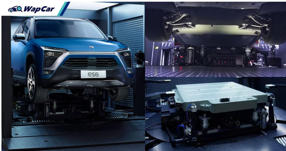
Obrázek 3 - Nio battery swapping stanice (zdroj: [19])
