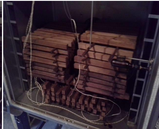
Obrázek 9 Uložení vzorků do termokomory (foto: Holeček)
