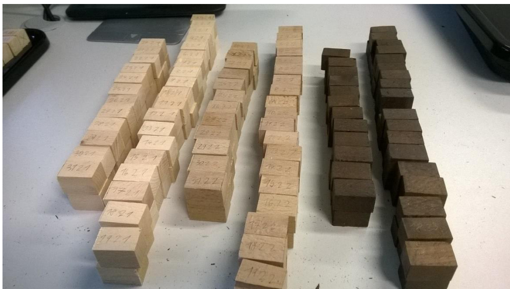
Obrázek 3 Vzorky tepelně upraveného bukového dřeva – zleva je referenční úprava, úprava na 165 °C a vpravo úprava na 210 °C
