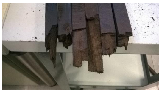
Obrázek 13 Vzorky po přerážecí zkoušce s úpravou na 210 °C
