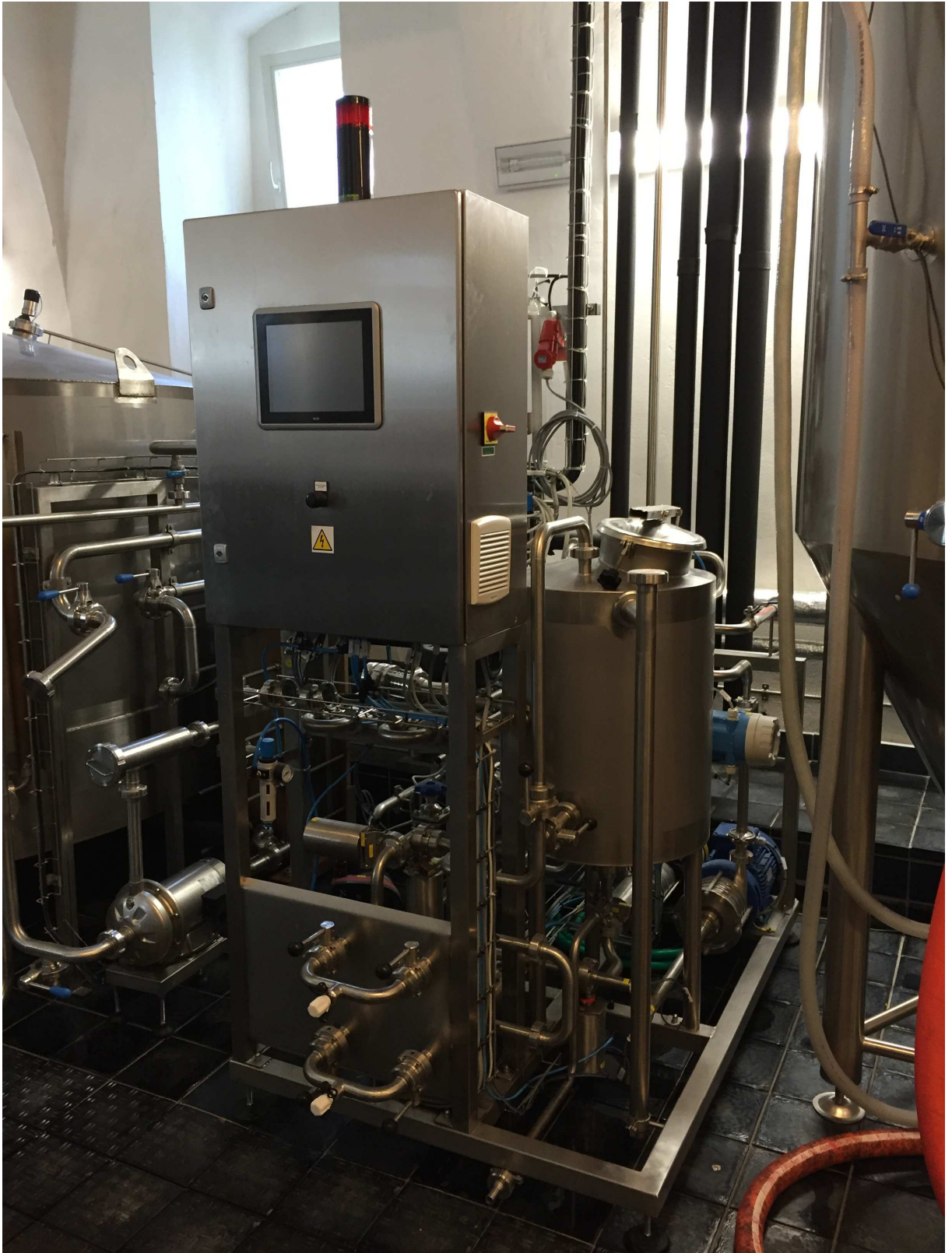
Fotografie 1: Průtokový pastér – ovládací panel a tank pro CIP
