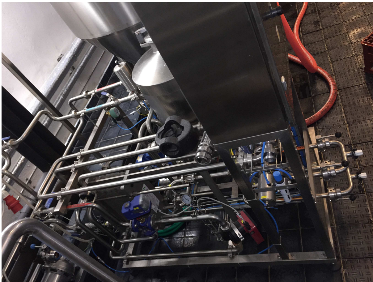
Fotografie 2: Průtokový pastér – trubkový výdržník
