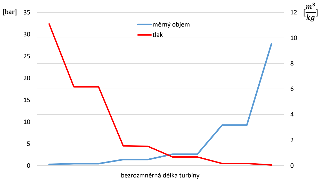
Obrázek 3.4 Změna tlaku a měrného objemu při průchodu turbínou
