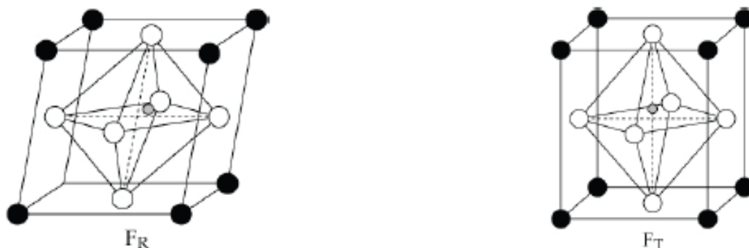
Obr. 2.2 Feroelektrická struktura PZT pod Curieovou teplotou – rhomboedrální ( F_R ) a tetragonální ( F_T ) [5]
