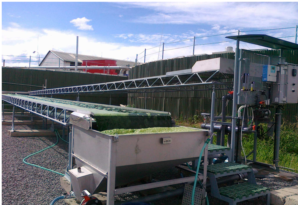
Foto 1. Plošinový fotobioreaktor v Dublovicích (v popředí sběrná nádrž, vpravo řídící panel a čerpadlo)
