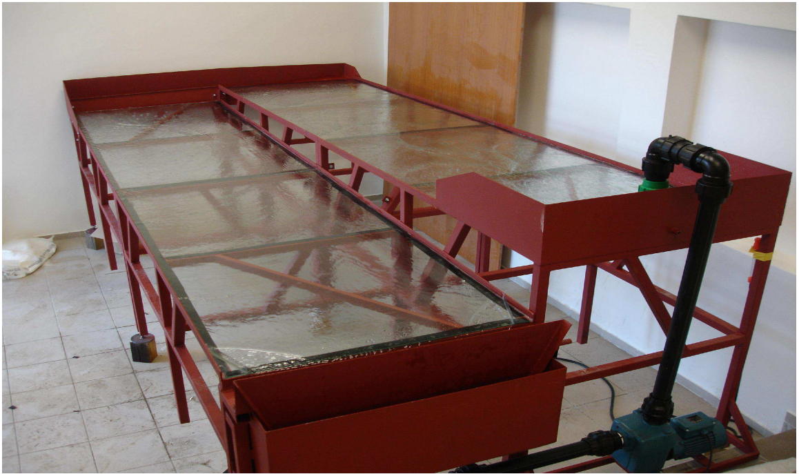
Obr. 4.2. Experimentální pošinový fotobioreaktor v areálu spalovny Liberec využívající reálné spaliny Autor: Ing. Petr Novák
