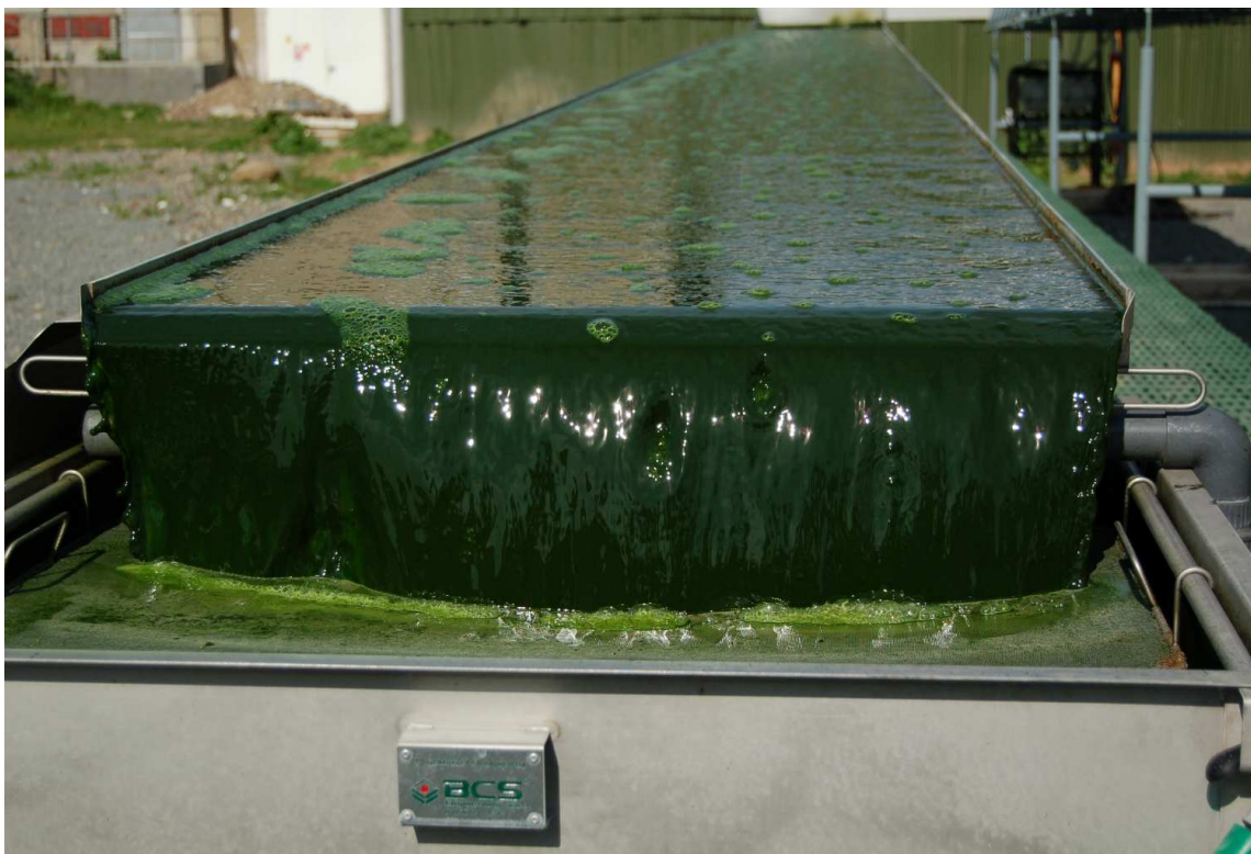
Foto 3. Konec kultivační plochy, přepad suspenze přes síto do sběrné nádrže
