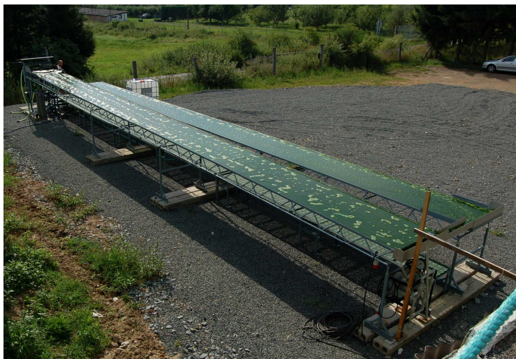
Foto 2. Pohled na bioreaktor z fermentační nádrže
