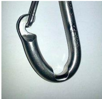
Obr. 3.2 Karabina vyrobená z austenitické oceli (X5CrNi 18-10) s viditelným opotřebením v místě styku karabiny a lezeckého lana [autor]
