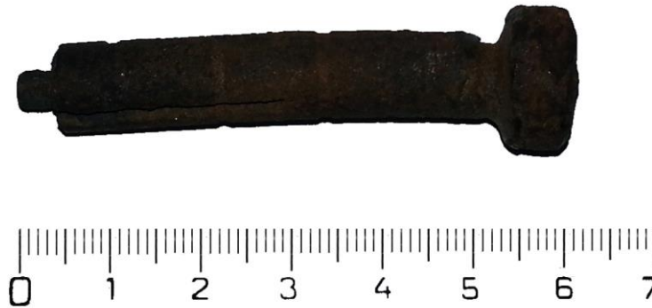
Obr. 3.3 Dřík zatloukacího expanzního nýtu s viditelným zářezem [autor]
