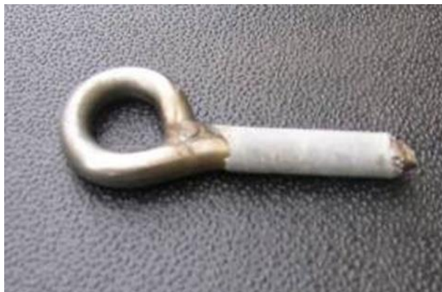
Obr. 3.13 Vytržený lepený borhák [24]
