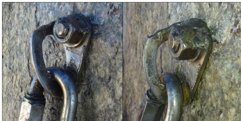
Obr. 3.14 Expanzní nýt s plaketou po úderu blesku [autor]
