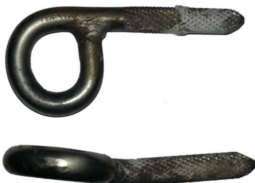
Obr. 2.4 Lepený borhák vyrobený z materiálu (X5CrNi 18-10) s viditelnou deformací ohybem [autor]
