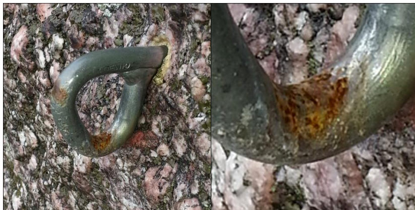
Obr. 3.9 Koroze v místě mechanického poškození borháku [autor]
