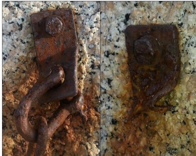
Obr. 2.1 Fixní zajištění osazené v roce 1990 v přímořské oblasti Cala Spinosa-Sardinie [autor]
