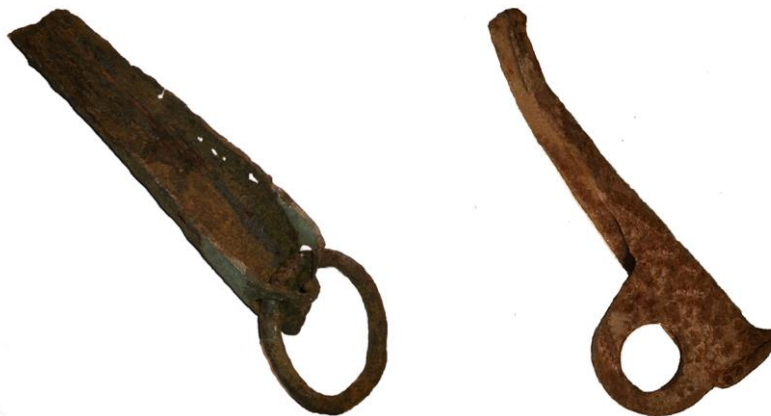
Obr. 3.5 Lezecké skoby napadené celkovou korozi, u skoby (vlevo) s viditelnými dírami [autor]
