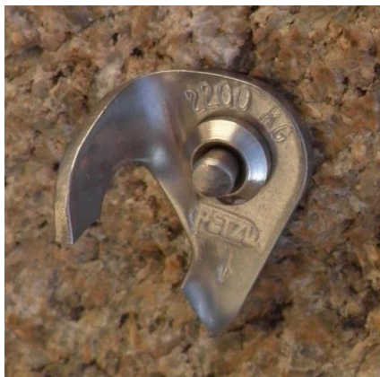
Obr. 3.1 Zatloukací expanzní nýt s plaketou značky Petzl s viditelným štěpným lomem [autor]
