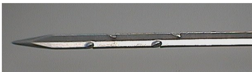
Obrázek 26: hrot jehly TriStar pod mikroskopem.
