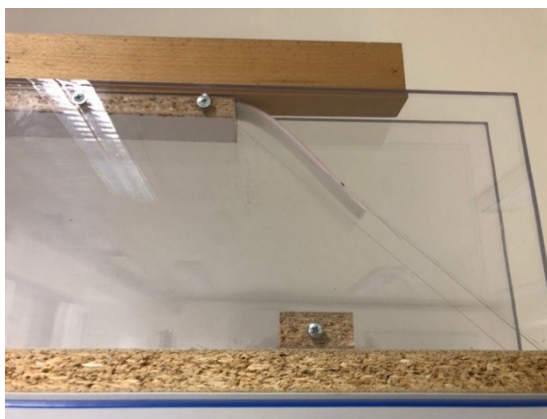
Obrázek 31: měření ohybové tuhosti.
