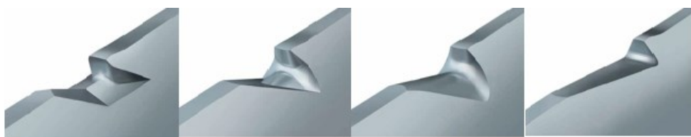
Obrázek 14: možné tvary zubů vpichovacích jehel. [18]
