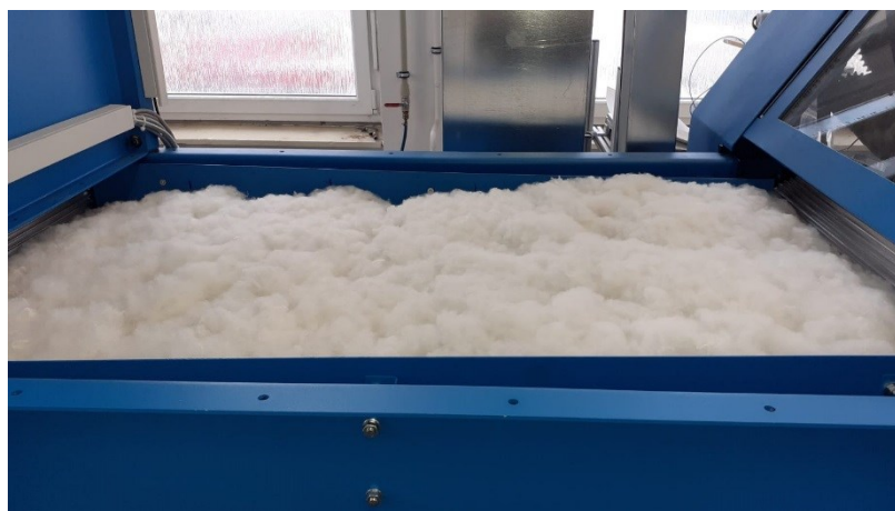
Obrázek 24: transport rouna do válcové mykačky.
