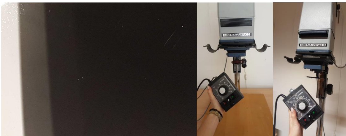
Obrázek 29 - Zkušební proužek papíru (osvětleno 0, 2, 4 a 6 s), osvětlovací přístroj MAGNIFAX3
