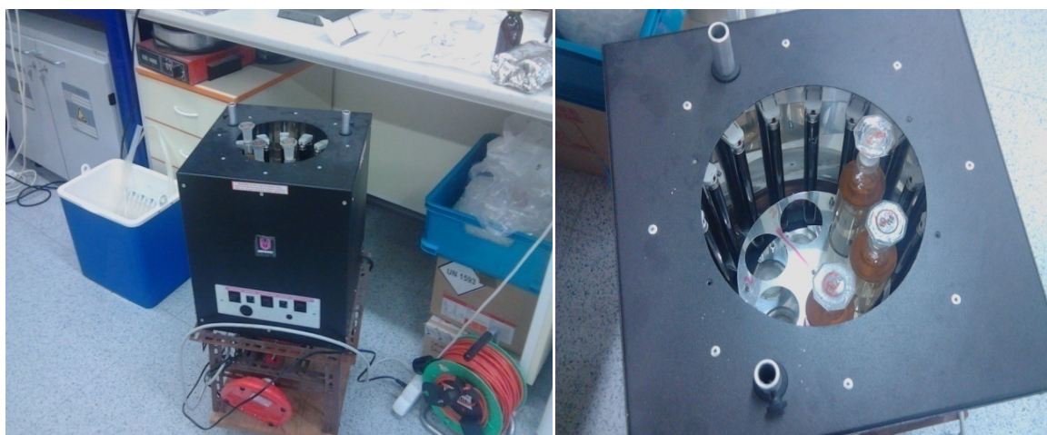
Obrázek 4: Ozařovací reaktor a vnitřní uspořádání vzorků.
