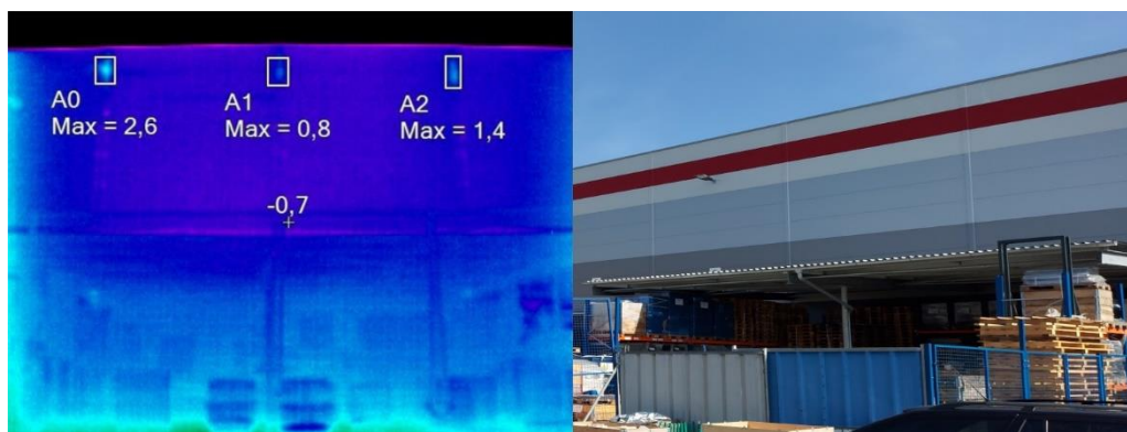
Příloha 30 Termovizní měření v exteriéru, západní obvodová konstrukce, jih, venkovní sklad
