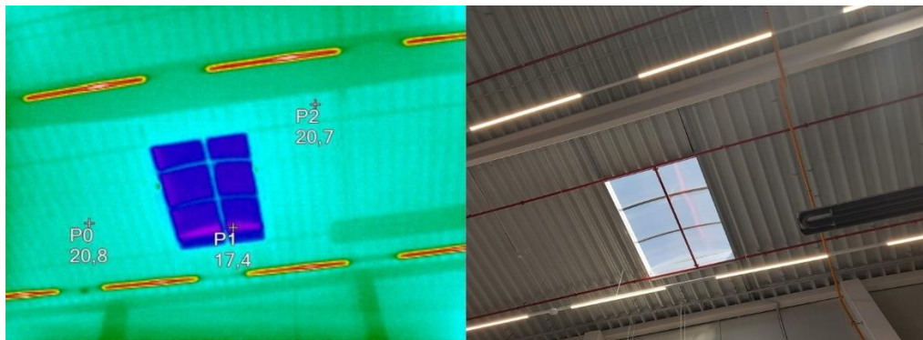
Příloha 60 Termovizní měření v interiéru, střeška na severní straně, západní část, detail
