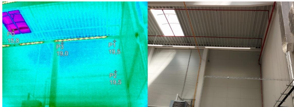
Příloha 45 Termovizní měření v interiéru, okno na severní straně, východ, druhé
