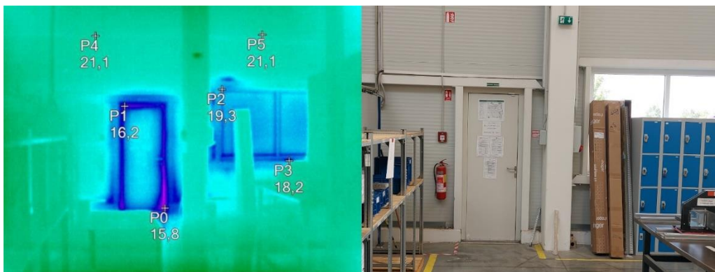
Příloha 54 Termovizní měření v interiéru, západní část, sever, horní část
