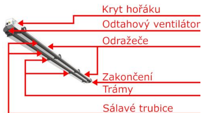
Obrázek 21 Popis tmavého plynové záříče Solar HP32 (22)
