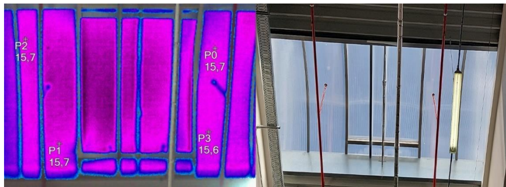
Příloha 61 Termovizní měření v interiéru, střeška na jižní straně, západní část, u stěny
