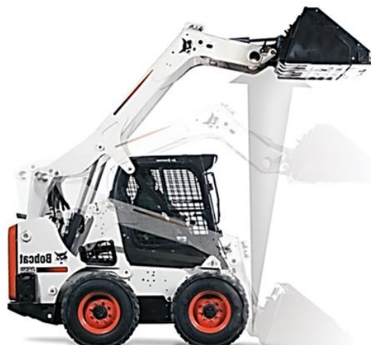
Obr. 6 Znárodnění vertikální trajektorie při zdvihu výložníku nakladače Bobcat S650 [10]
