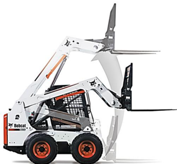
Obr. 5 Znárodnění radiální trajektorie při zdvihu výložníku nakladače Bobcat S630 [9]
