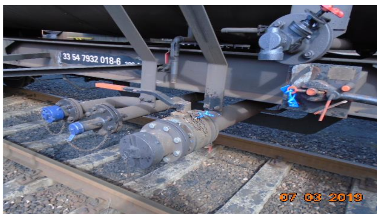
Obr. 4.4 Zaplombované vypouštěcí zařízení
