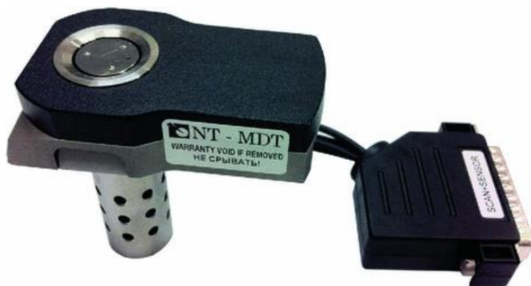
Obr. 24: Piezokeramický skener s magnetickým podstavcem na uchycení vzorků [27].
