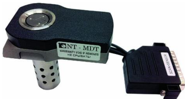
Obr. 24: Piezokeramický skener s magnetickým podstavcem na uchycení vzorků [27].
