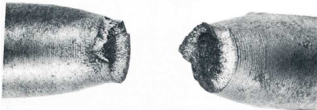
Obr. 8 Přetržení kruhové tyče u houževnatého materiálu [23]
