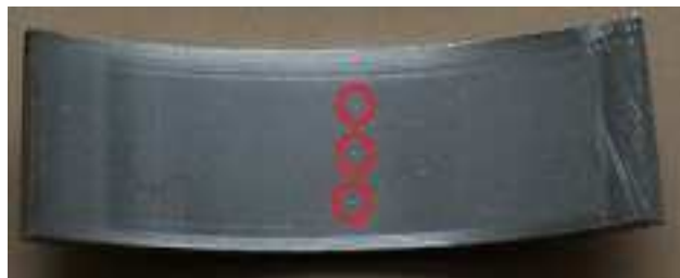
Obr. 45 Vtisky na prstencovém vzorku
