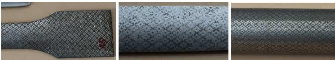
Obr. 26 Příklady vzorků s nanesenou deformační sítí
