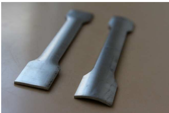
Obr. 20 Rozdíl mezi rovnou a segmentovou hlavou
