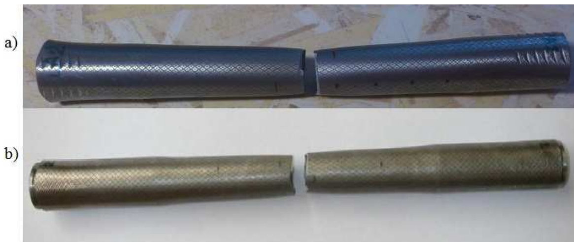
Obr. 32 Přetržená celistvá trubka: a) tloušťka stěny 1,5 mm b) tloušťka stěny 1 mm
