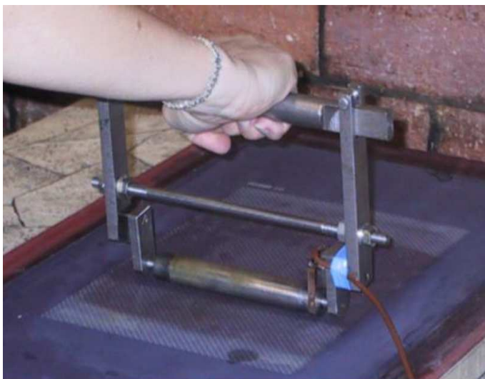
Obr. 25 Přípravek pro nanášení sítě na trubky
