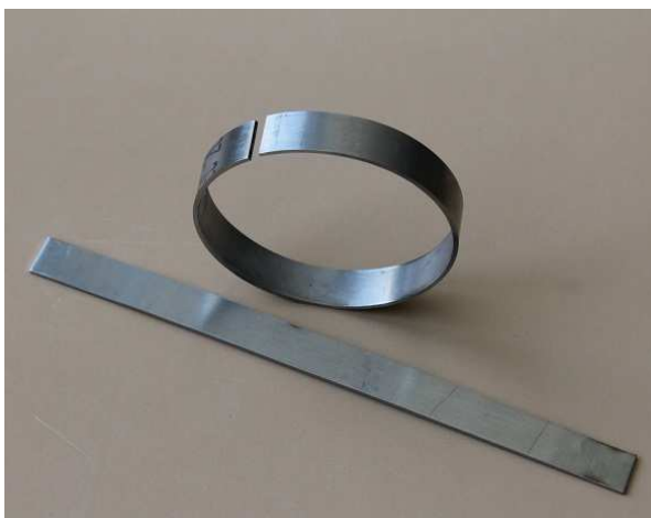
Obr. 21 Příčný výřez zkušební tyče
