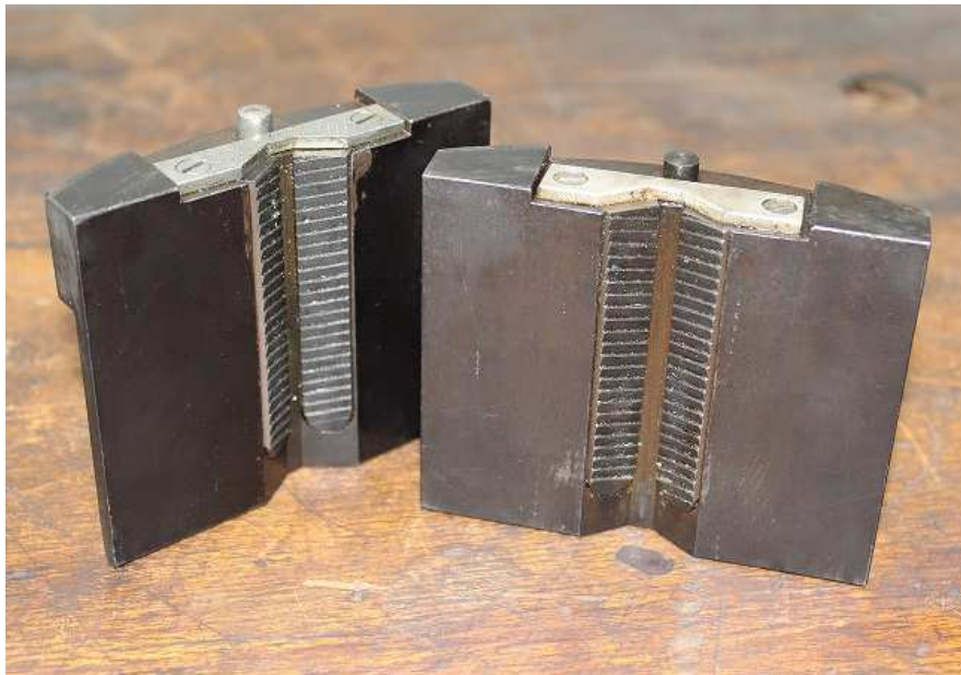
Obr. 18 Čelisti použité pro tahovou zkoušku celistvých trubek
