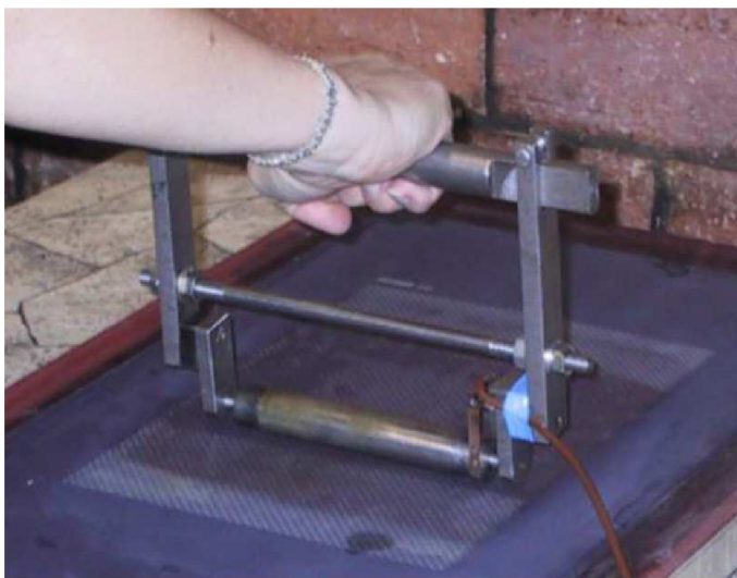
Obr. 25 Přípravek pro nanášení sítě na trubky
