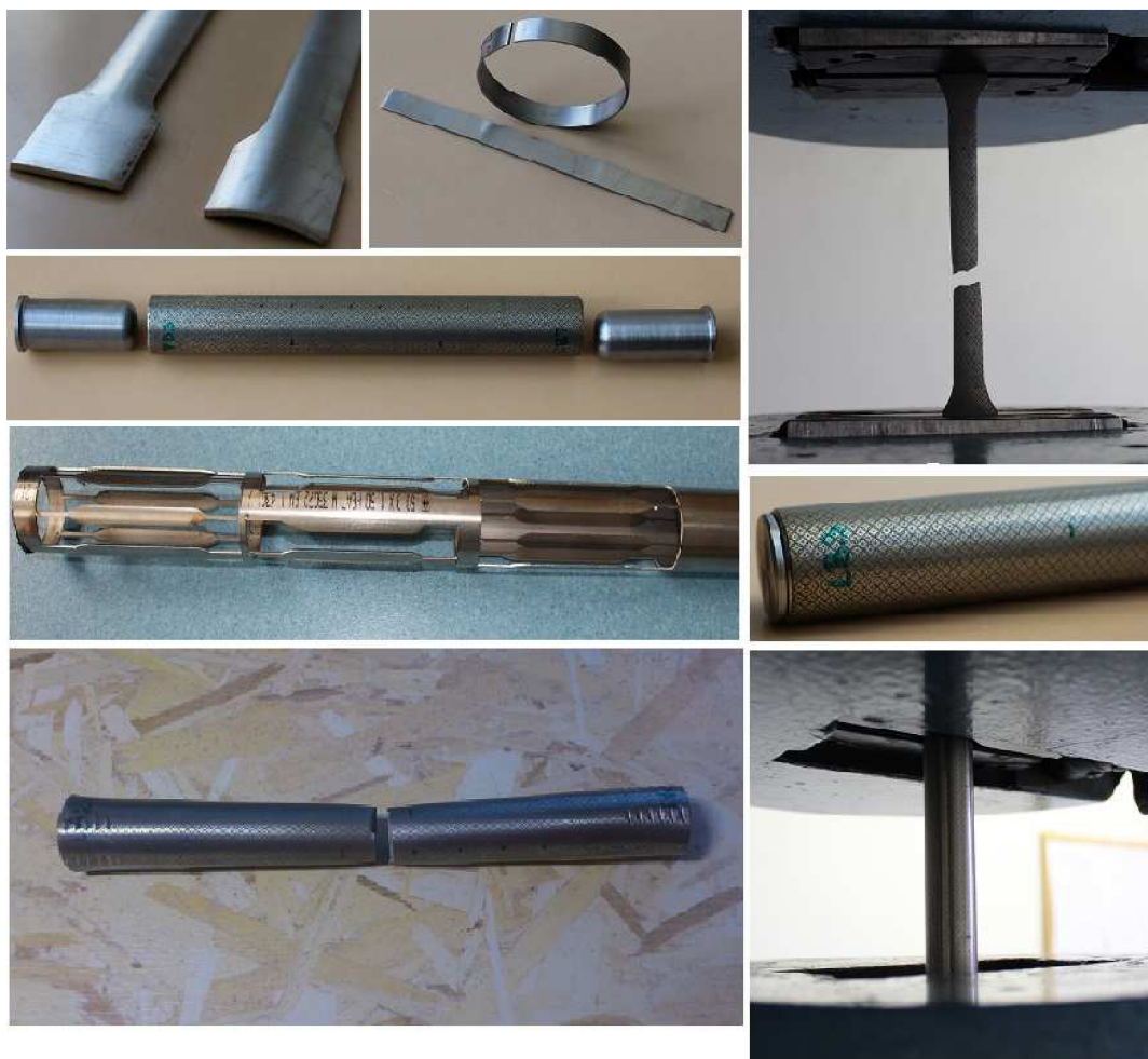
Obr. 1 Příklady vzorků pro tahovou zkoušku z trubek
