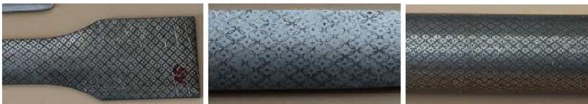
Obr. 26 Příklady vzorků s nanesenou deformační sítí
