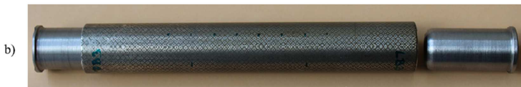
Obr. 16 Celistvá trubka: a) schéma s rozměry, b) skutečný vzorek
