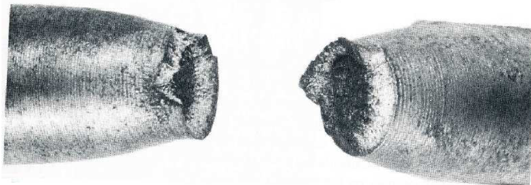
Obr. 8 Přetržení kruhové tyče u houževnatého materiálu [23]
