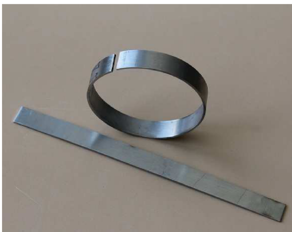
Obr. 21 Příčný výřez zkušební tyče
