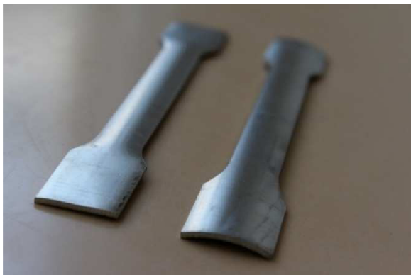
Obr. 20 Rozdíl mezi rovnou a segmentovou hlavou
