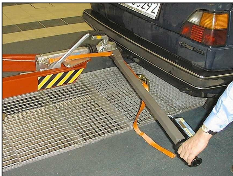
Obr. 9 – Zkoušení nájezdové brzdy prováděné měřicím zařízením WN 500 (CYLEK-FICEK 2010)
