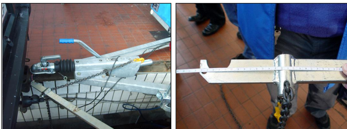
Obr. 10 – Páka pro aktivaci nájezdové brzdy (CYLEK-FICEK 2010)
