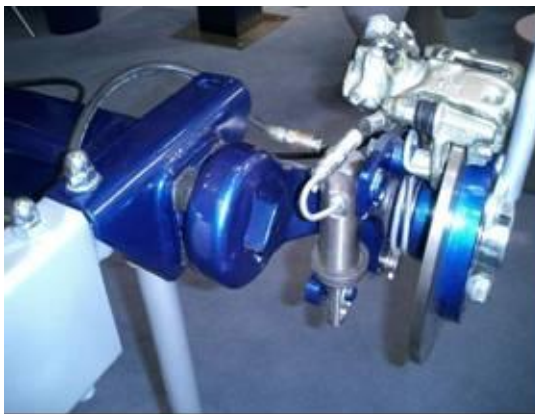
Obr. 3 – Kolová jednotka kotoučové brzdy s plovoucím třmenem (HÜHNE 2009)
