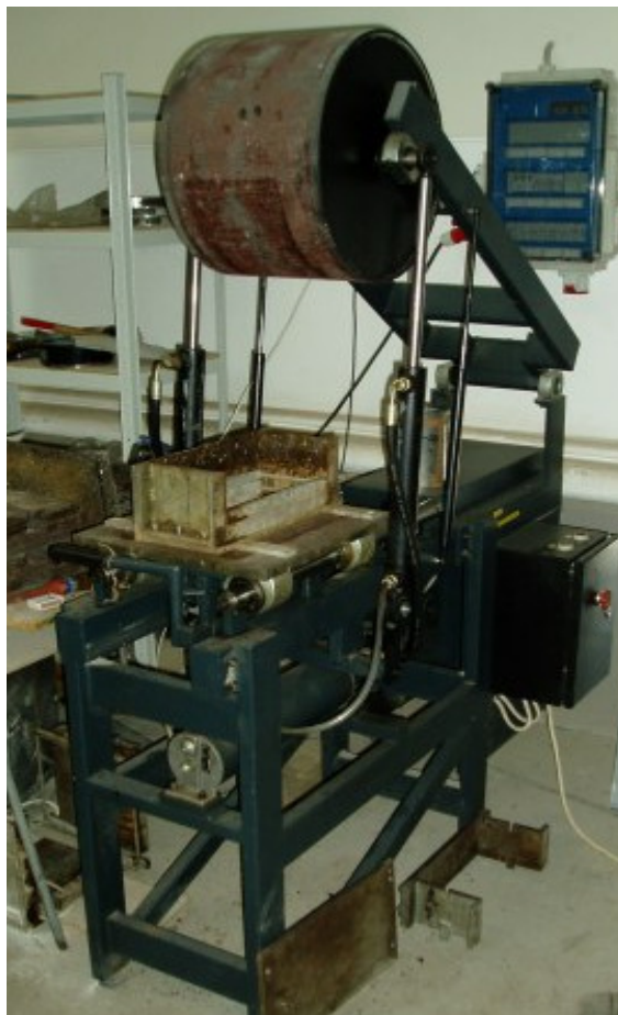
Obrázek 19 – Lamelový zhutňovač pro hutnění desek
