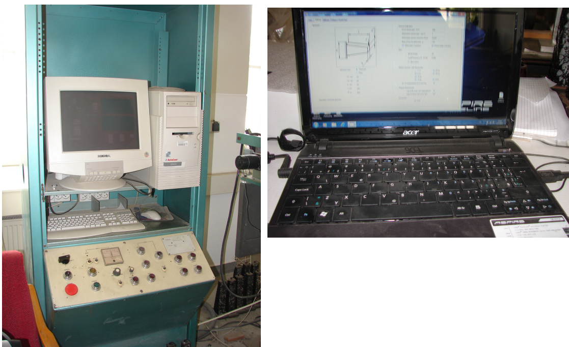
Obrázek 26, 27 – Zařízení pro změnu frekvence a program na zjištění modulu tuhosti
