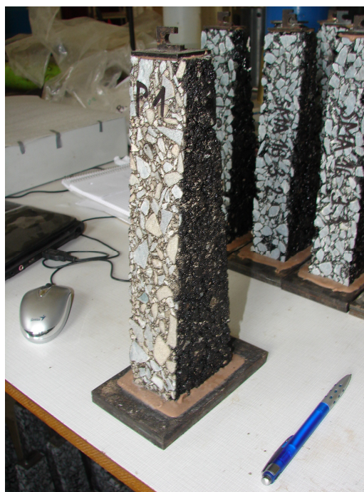
Obrázek 22, 23 – Ořezaný a neořezaný zkušební vzorek
