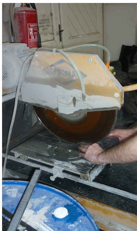
Obrázek 20 – Kotoučová pila k rozřezání desek na trapezoidy
