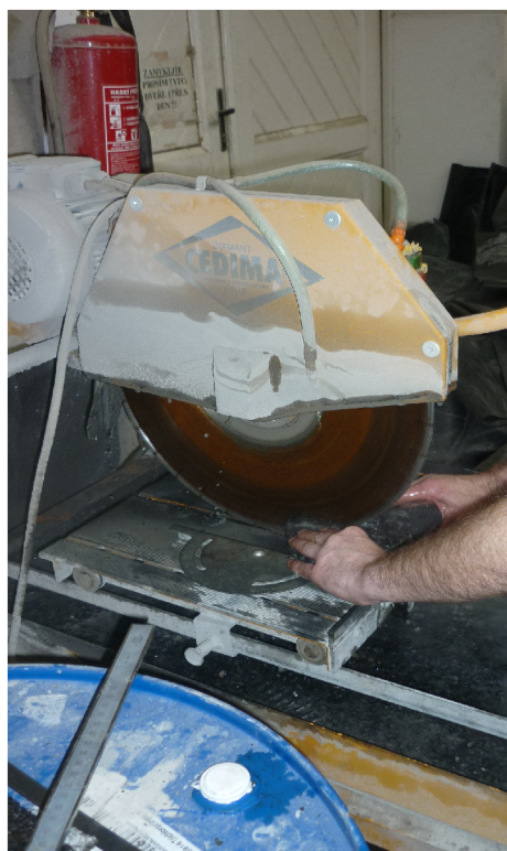
Obrázek 20 – Kotoučová pila k rozřezání desek na trapezoidy
