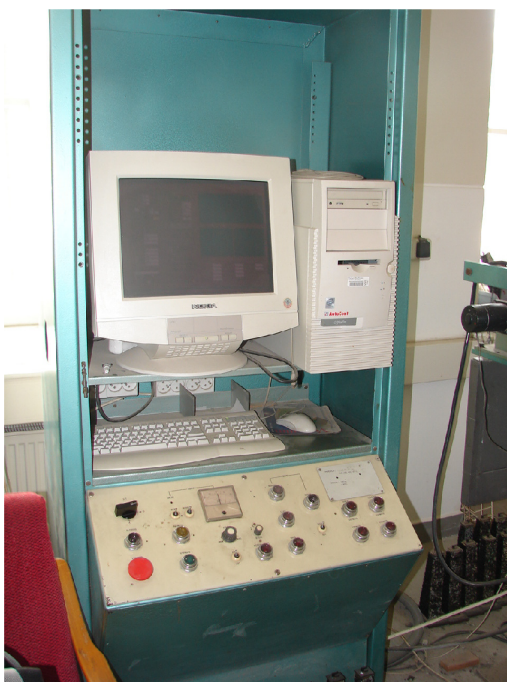
Obrázek 26, 27 – Zařízení pro změnu frekvence a program na zjištění modulu tuhosti
