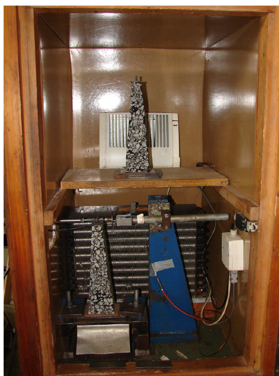
Obrázek 25 – Vzorek připevněný ke zkušebnímu zařízení v temperovací komoře
