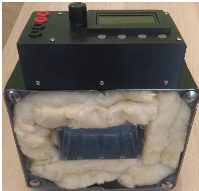
Obr. 3.8 Otevřená komora s izolací
