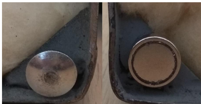
Obr. 3.6 Detail magnetického spoje složeného z vratového šroubu (nalevo) a magnetického úchytu s vnějším závitem
