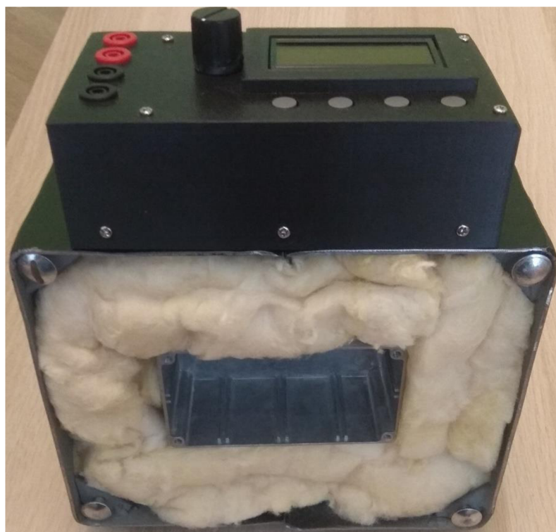
Obr. 3.8 Otevřená komora s izolací
