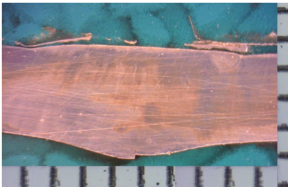
Obr. 50 Makrovýbrus svarového spoje TIG-TIG (doplněna milimetrová stupnice)
