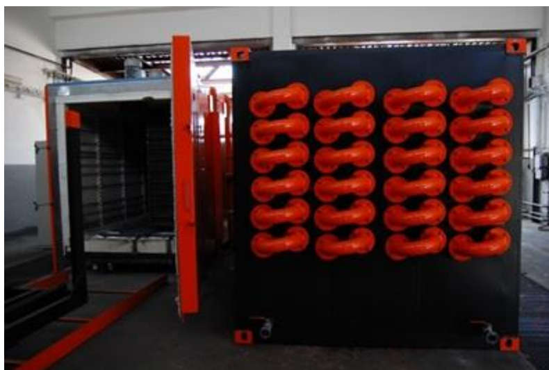
Obr. 5 Fotografie pece (vlevo) a chladiče plynů [2]
