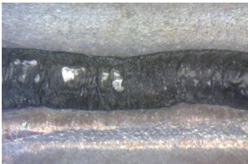
Obr. 37 Kořen svaru TIG-CMT po zkoušce lámavosti (zvětšeno 20x)
