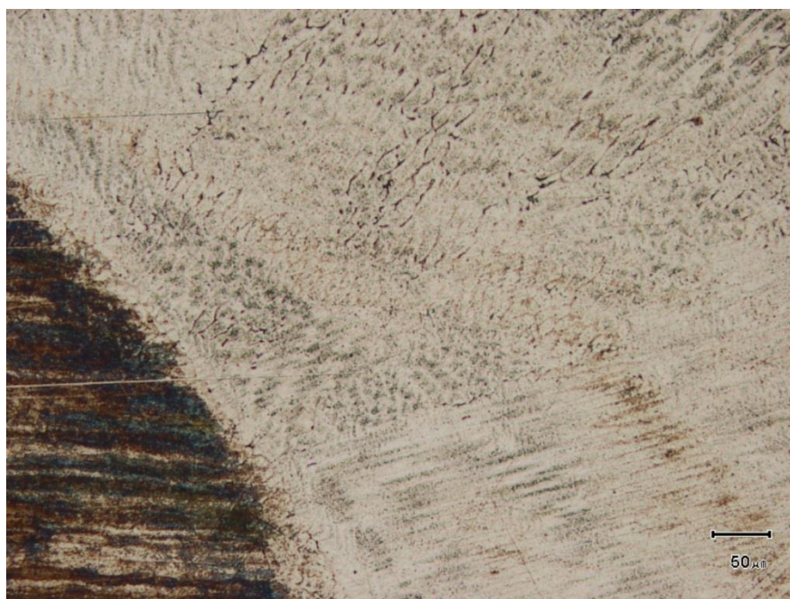
Obr. 62 Přechod mezi svarovým kovem a tepelně ovlivněnou oblastí TIG-CMT
