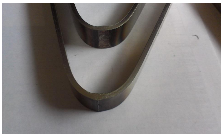
Obr. 32 Detail vzorků po zkoušce ohybem
