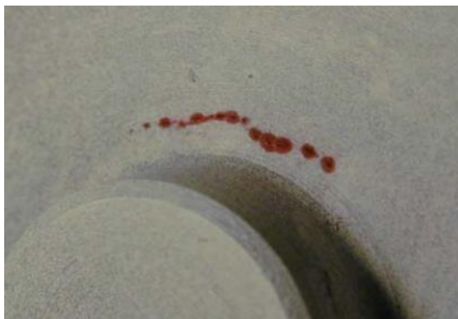
Obr. 22 Ilustrační obrázek výsledku penetrační zkoušky [36]
