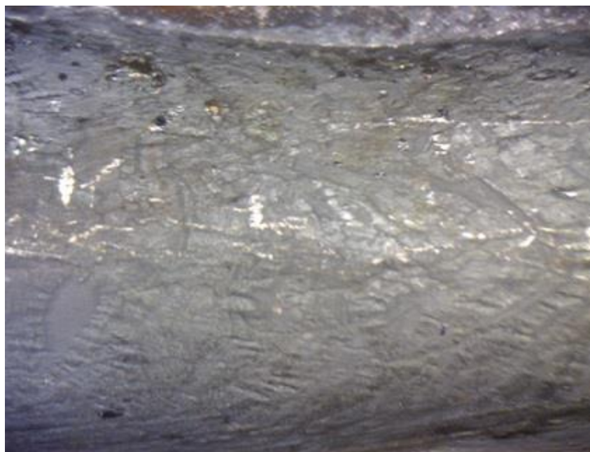
Obr. 38 Povrch svaru TIG-CMT po zkoušce lámavosti (zvětšeno 20x)
