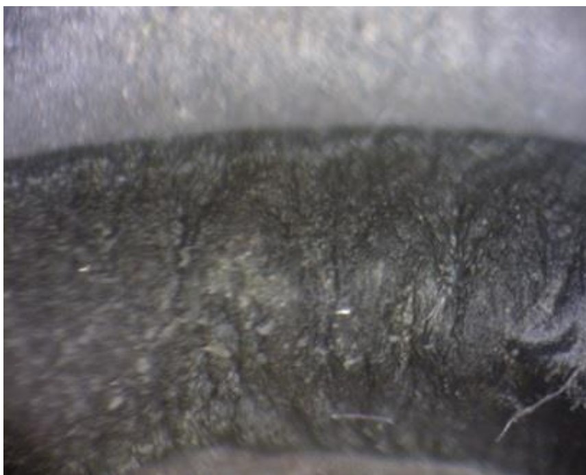
Obr. 36 Povrch svaru TIG-MAG po zkoušce lámavosti (zvětšeno 20x)
