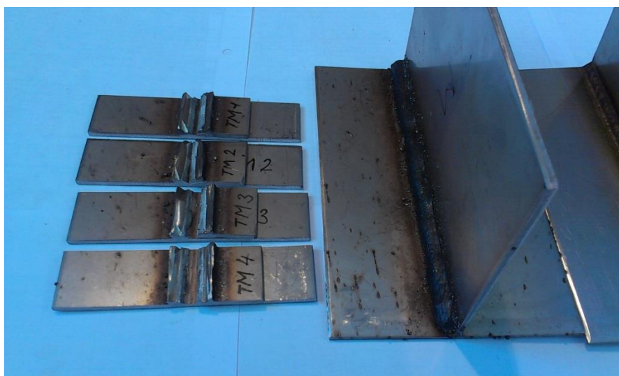
Obr. 44 Vzorky TIG-TIG pro zkoušku rozlomením
