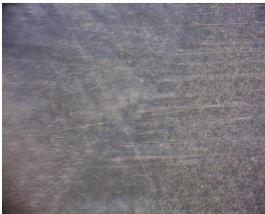
Obr. 51 Detail hranice svarového kovu a tepelně ovlivněné oblasti.
