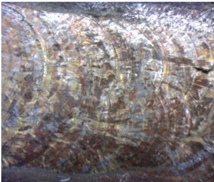
Obr. 33 Kořen svaru TIG-TIG po zkoušce lámavosti (zvětšeno 20x)
