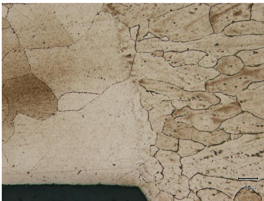
Obr. 60 Zhrubnutí zrna v mikrostruktuře TIG-MAG
