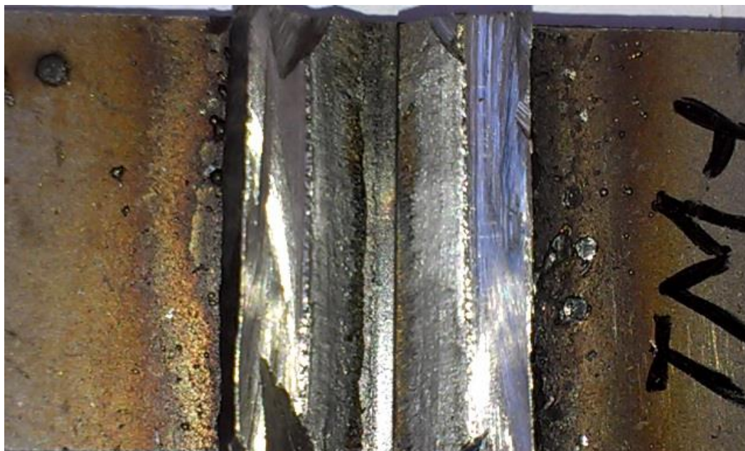
Obr. 45 Detail vzorku TIG-MAG po zkoušce rozlomením
