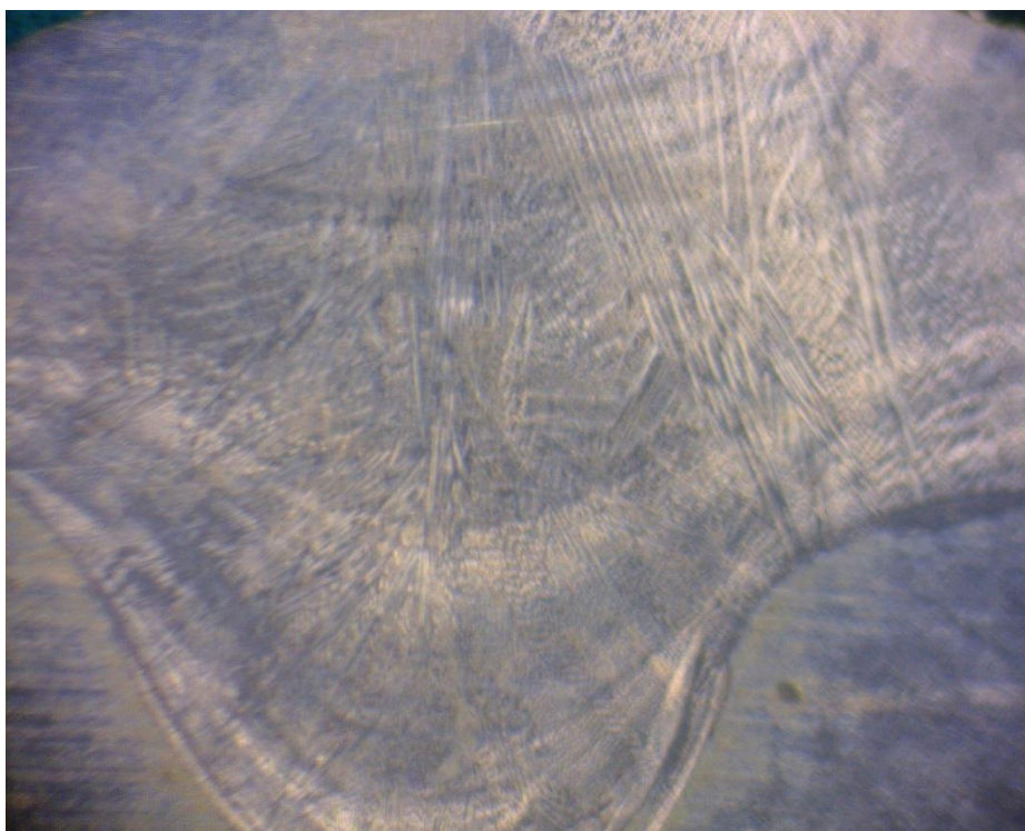
Obr. 56 Detail dendritických zrn v CMT svaru.
