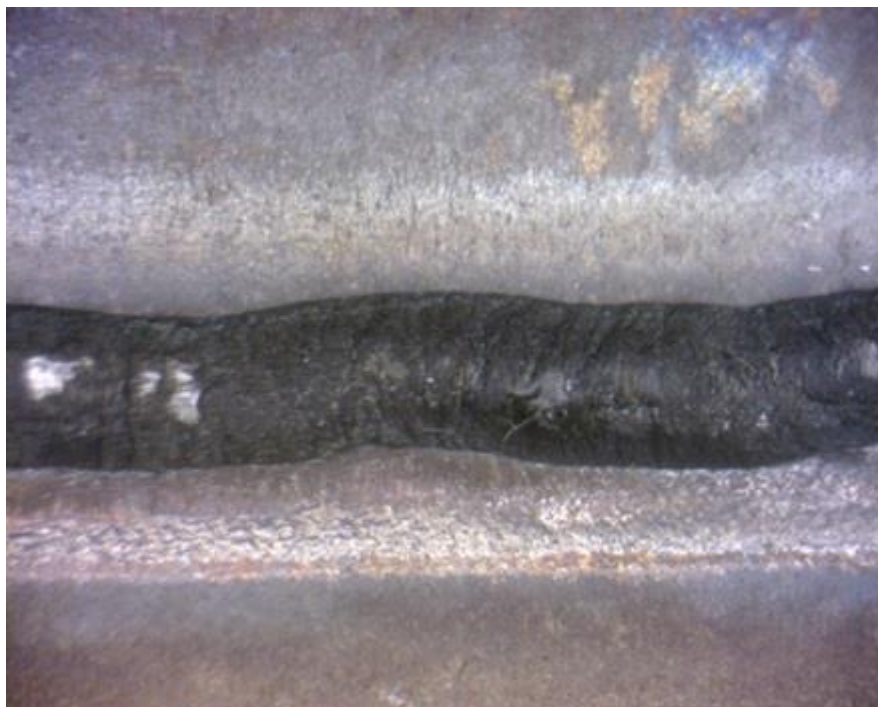
Obr. 35 Kořen svaru TIG-MAG po zkoušce lámavosti (zvětšeno 20x)
