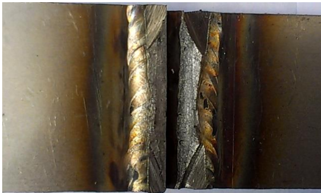
Obr. 41 Detail vzorku TIG-TIG po zkoušce rozlomením
