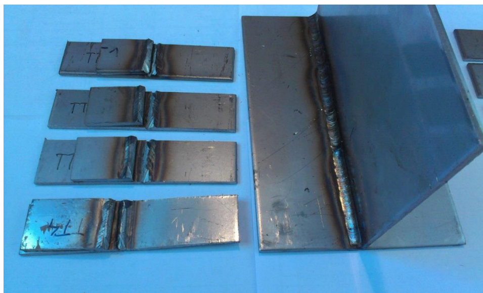
Obr. 40 Vzorky TIG-TIG pro zkoušku rozlomením
