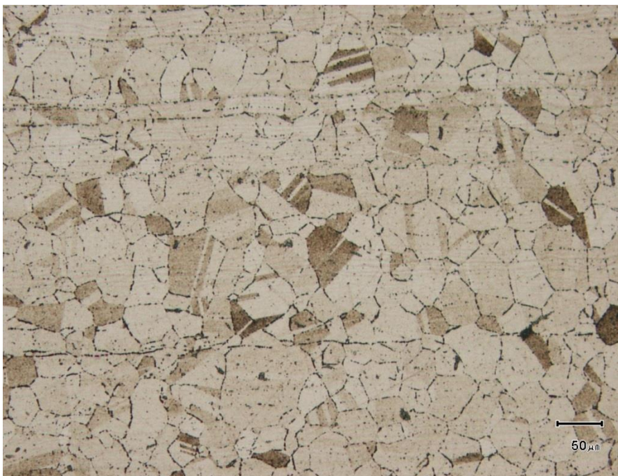
Obr. 57 Mikrostruktura základního materiálu
