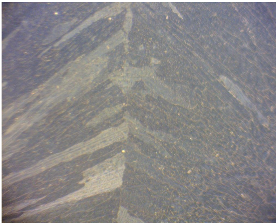
Obr. 54 Detail dendritických zrn sbíhajících se do svislé linie ve svaru MAG
