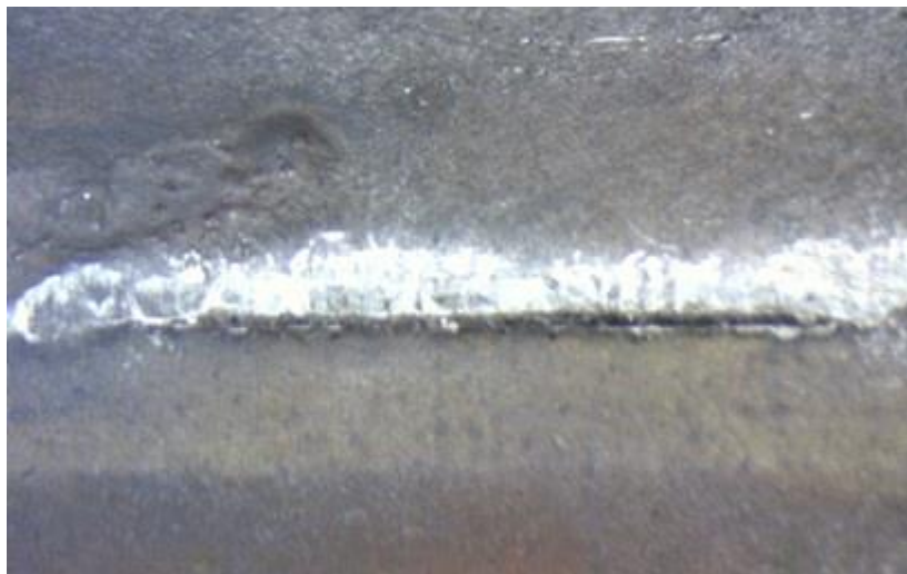
Obr. 33 Kořen svaru TIG-TIG po zkoušce lámavosti (zvětšeno 20x)
