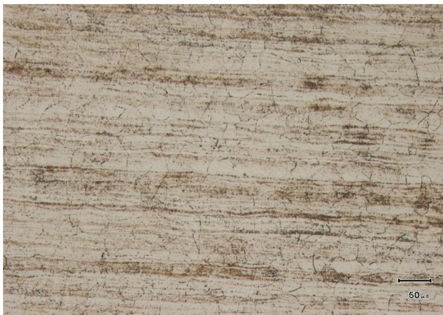
Obr. 58 Mikrostruktura svarového kovu TIG-TIG
