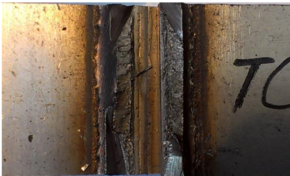
Obr. 48 Detail vzorku TIG-CMT po zkoušce rozlomením
