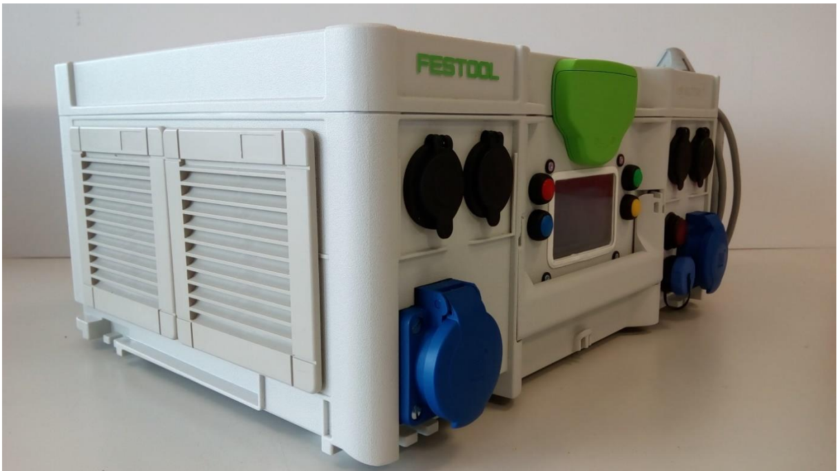
Obr. 10-8 Dokončená nabíjecí stanice
