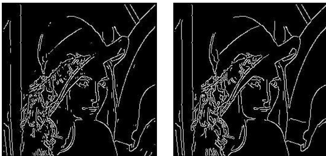
Obrázek 5.2ab: Prahování obr. 4.14b – (a) globální s hodnotou 96, (b) hysterezní hodnotami 128 a 64.
