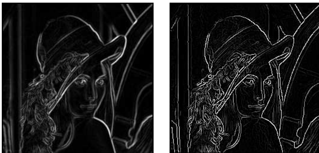
Obrázek 4.14ab: (a) Gradientní obraz, (b) Gradientní obraz po ztenčení
