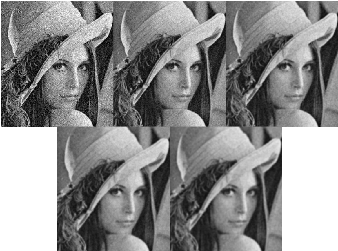
Obrázek 3.4: Gaussův filtr - (horní řada zleva) zašuměný originál, jádro 3x3, jádro 5x5 (dolní řada zleva) jádro 7x7, jádro 9x9
