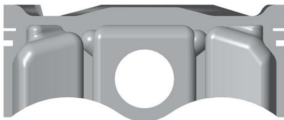
Obr. 21 Řez pístem podle osy symetrie
