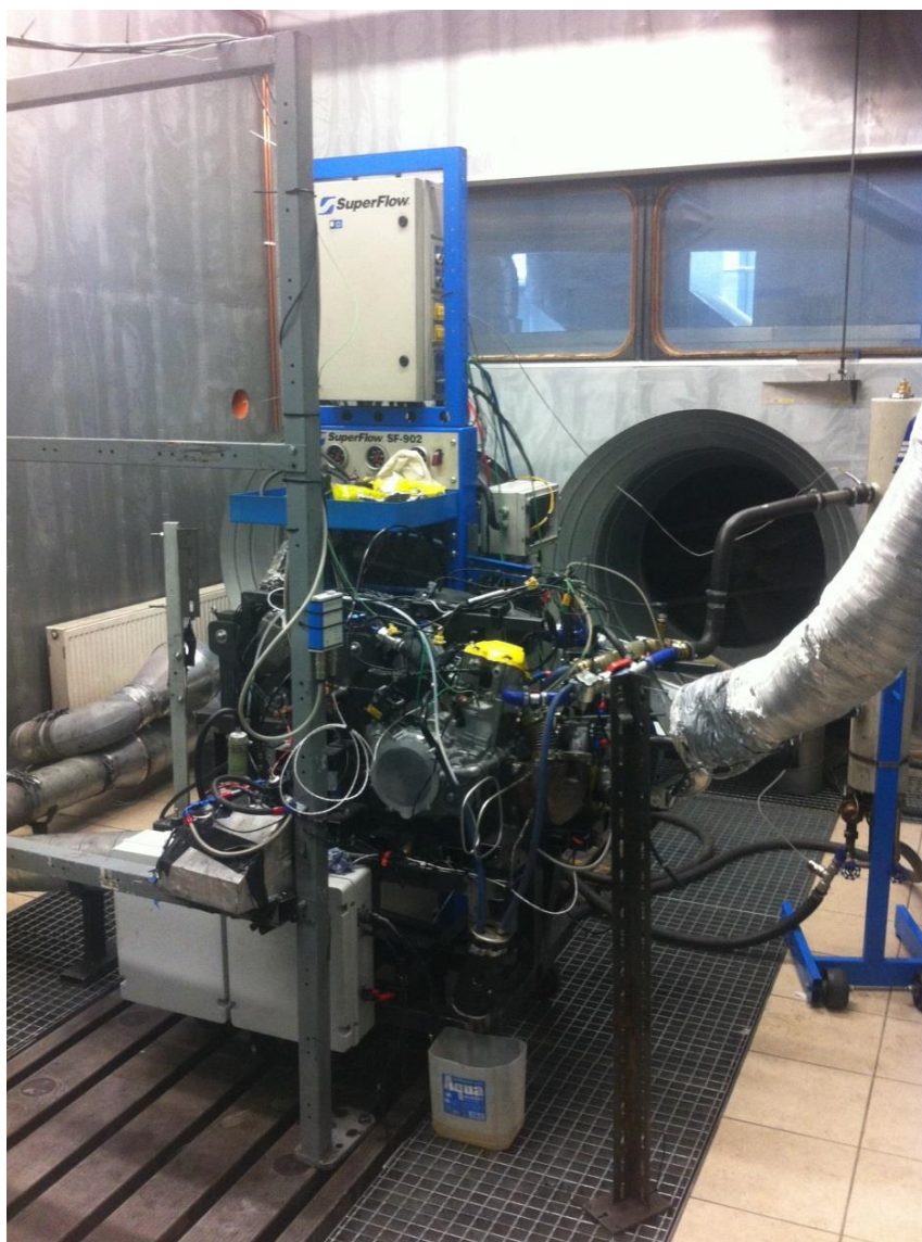
Obr. 32 Motor Husqvarna FE 501 na motorové brzdě SuperFlow SF 902
