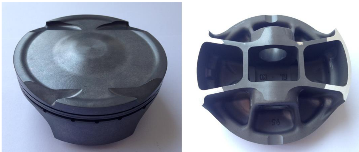
Obr. 15 Původní píst motoru Husqvarna FE 501s přirozeným sáním
