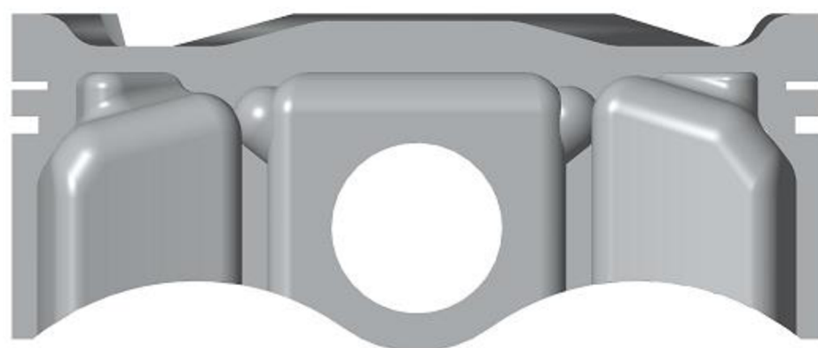
Obr. 21 Řez pístem podle osy symetrie
