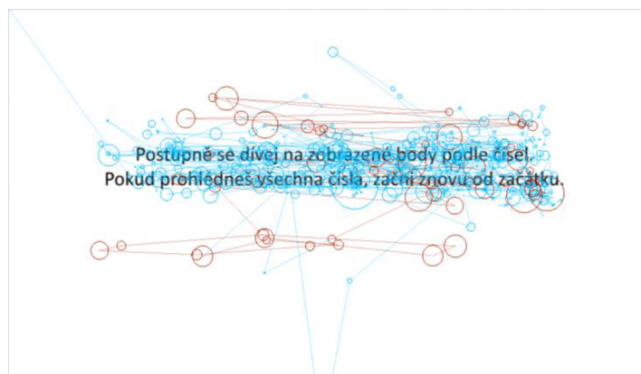
Obr. 33: Srovnání dat z SMI (azurová) a z GazeRecorder (červená) – kamera Logitech Quickcam Pro 5000
