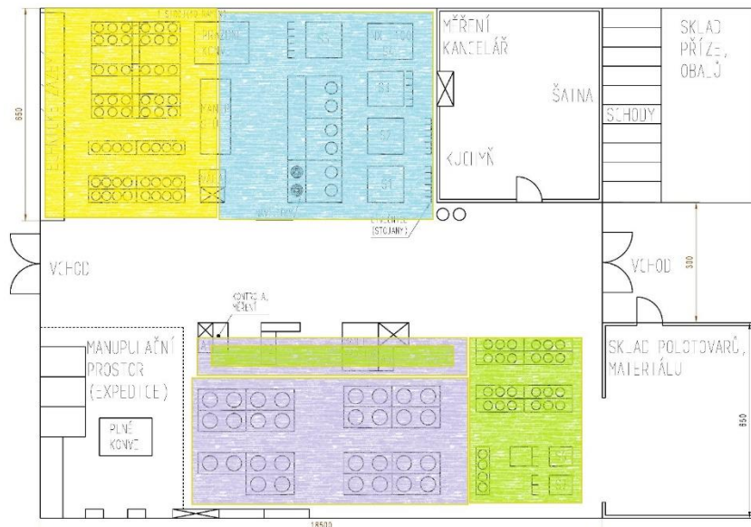
Obrázek 23. Nové úseky toku materiálu po optimalizaci pracoviště
