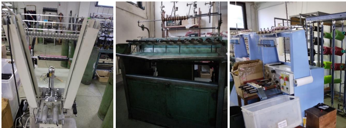
a) automatický b) poloautomatický c) poloautomatický Obrázek 3. Druhy soukacích zařízení zn. a) BTTO, b) neznámý, c) Talleres Ratera S.A.
