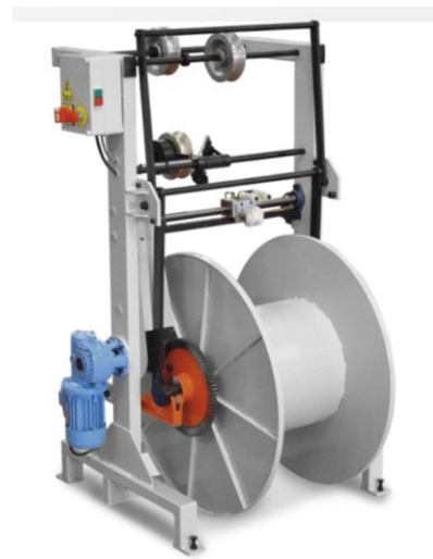
Obrázek 25. Příslušenství a) stávající, b) Ratera collector 800x400 [29]
