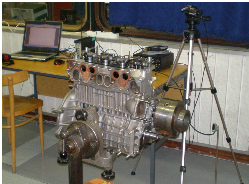
Obr. 49 Měření vlivu ventilové vůle na hluk rozvodového mechanismu
