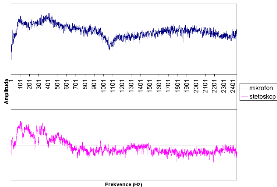
Obr. 45 Frekvenční charakteristika měřicího mikrofону a stetoskopu
