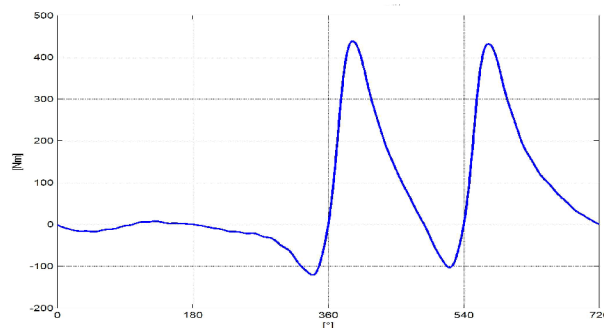
Obr. 34 Průběh točivého momentu dvouválcového motoru před setrvačником
