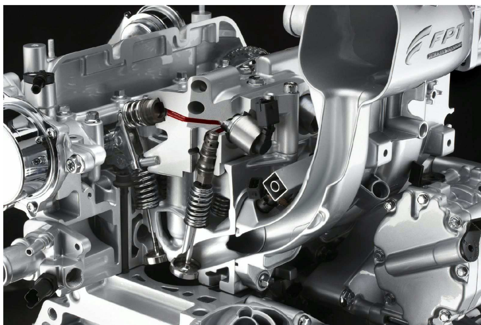
Obr. 29 Ovládání ventilů Multi-Air [46]
