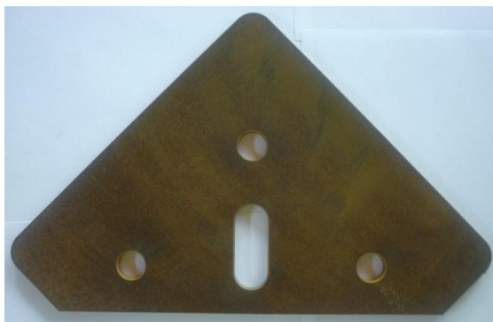
Obr. 37 Posuzovaná součást “patka sloupku“ – vodní paprsek
