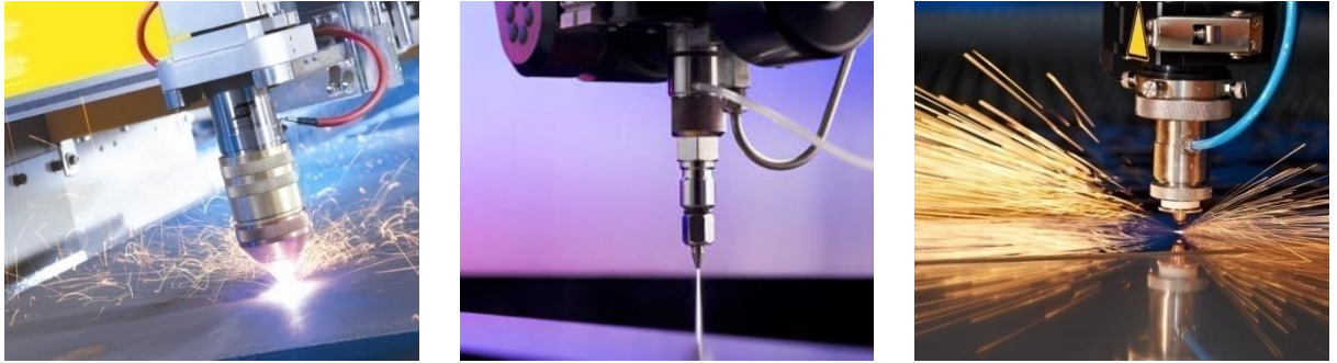
Obr. 6 Nekonvenční technologie výroby rovinných dílců z plechu plazmový paprsek / vodní paprsek / laserový paprsek [1, 36, 68]
