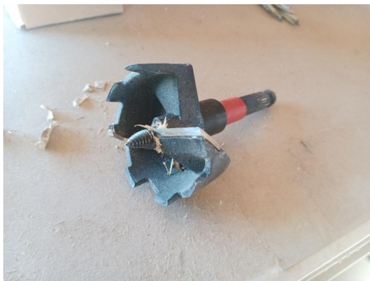
Obrázek 28 Forstnerův vrták s jediným hlavním řezným břitem
