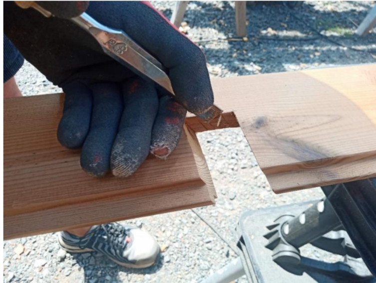
Obrázek 16 Ruční dočištění řezu dlátem
