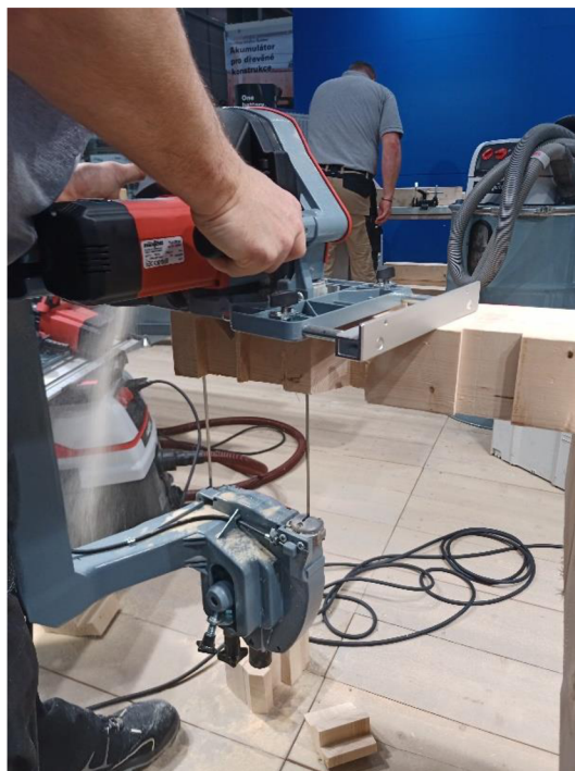
Obrázek 7 Řez pravým během pásu
