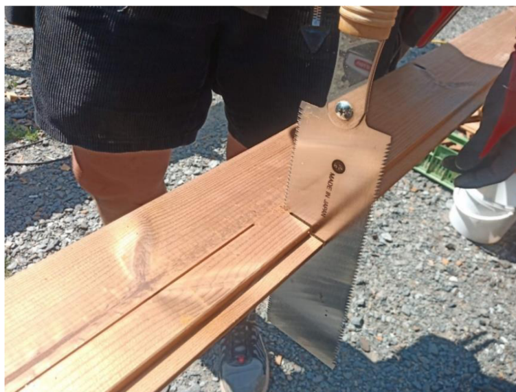
Obrázek 1 Řez detailu ruční pilou
