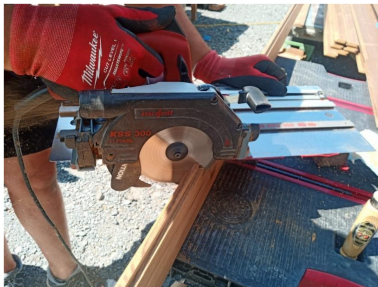
Obrázek 11 Ruční okružní pila s kapovací lištou
