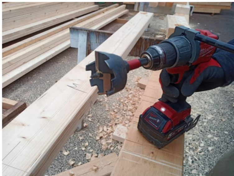
Obrázek 26 Vrtačka s upnutým Forstnerovým vrtákem a pomocným madlem pro zvýšení ovladatelnosti
