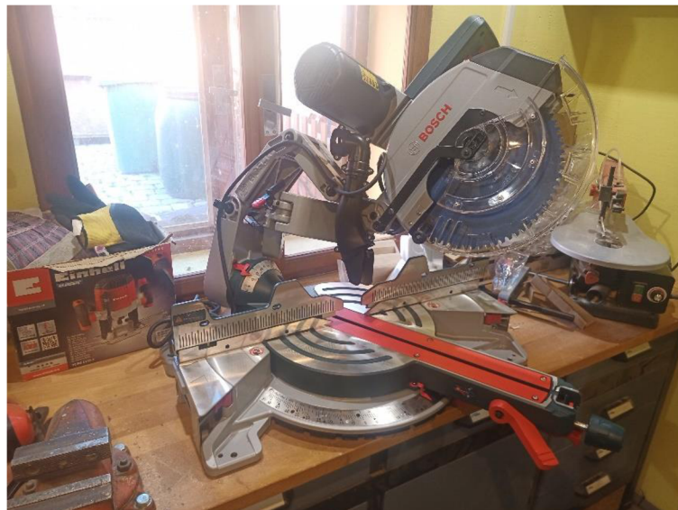
Obrázek 12 Pokosová pila v nastavení pro řez pod úhlem pokosu 15^\circ a stranovým úhlem 30^\circ
